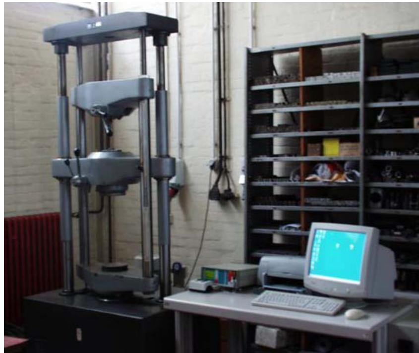
Slika 20 Hidraulična kidalica WPM EU 40 mod.
