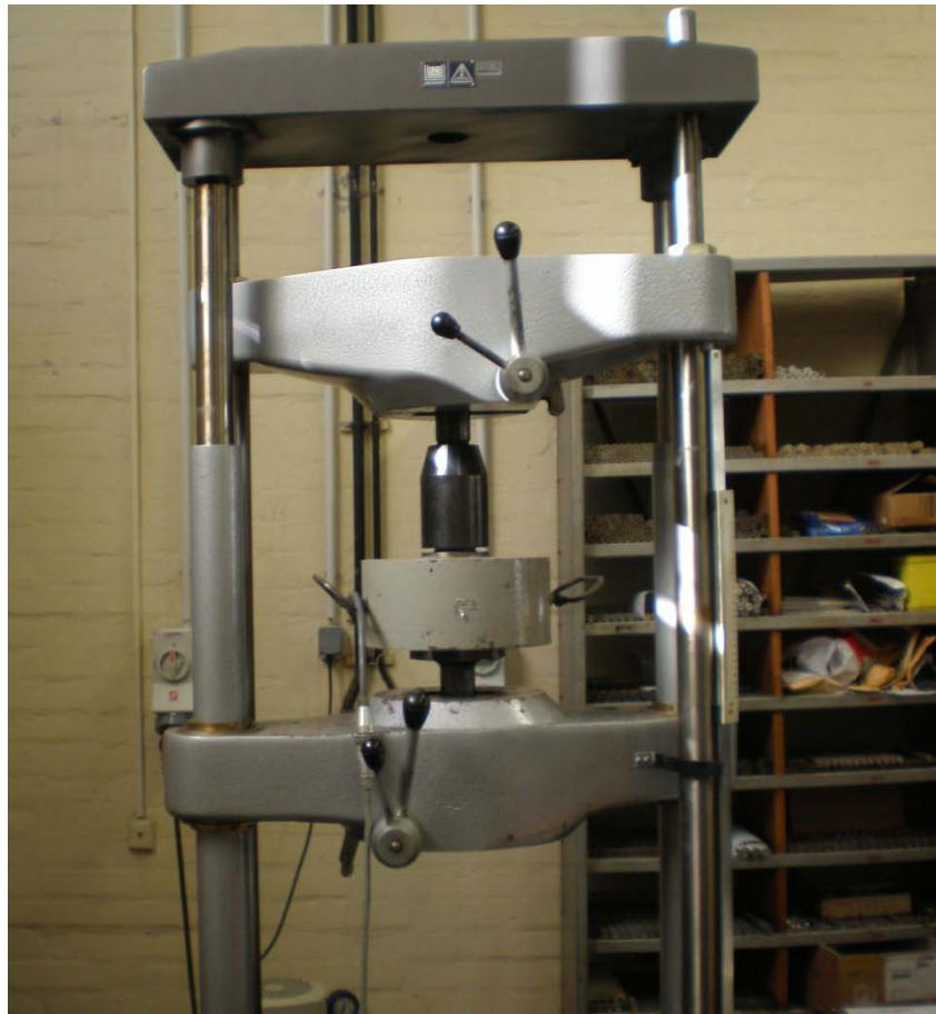
**Slika 26 Vlačno umjeravanje kidalice**
