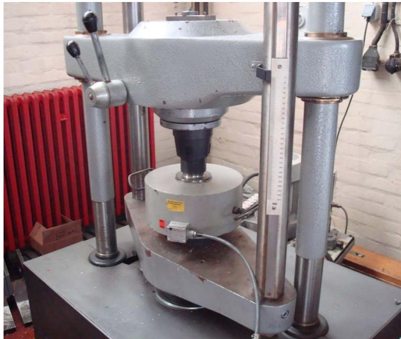
**Slika 24 Tlačno preopterećivanje kidalice i dinamometra**
