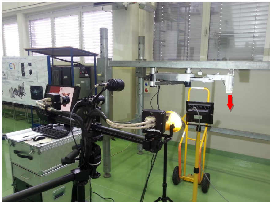
Slika 7.1 Položaj i opterećenje Forerunnera [18]
