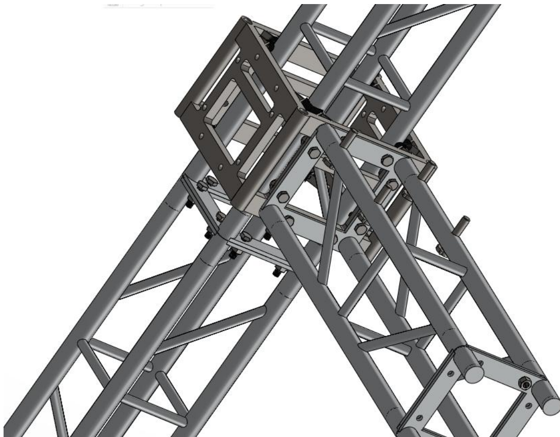
Slika 12. Sklop kolica i nosača sa vijcima i maticama
