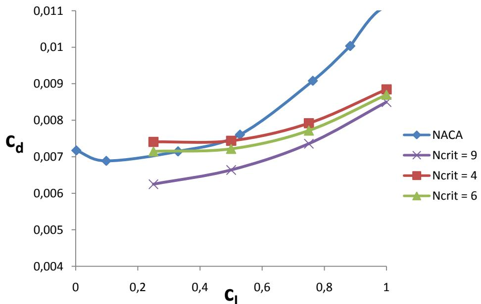
Slika 2.4.5: Usporedba rezultata polare za  $Re = 2.6 \times 10^6$
