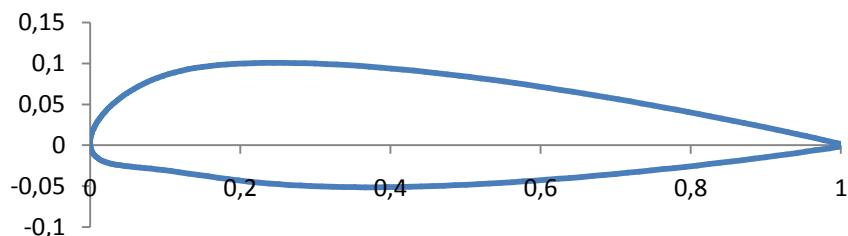
**Slika 3.2.1: Aeroprofil NACA 43015**
