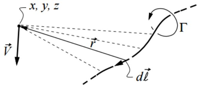
Slika 2.3.1: Brzina inducirana vrtložnom niti
