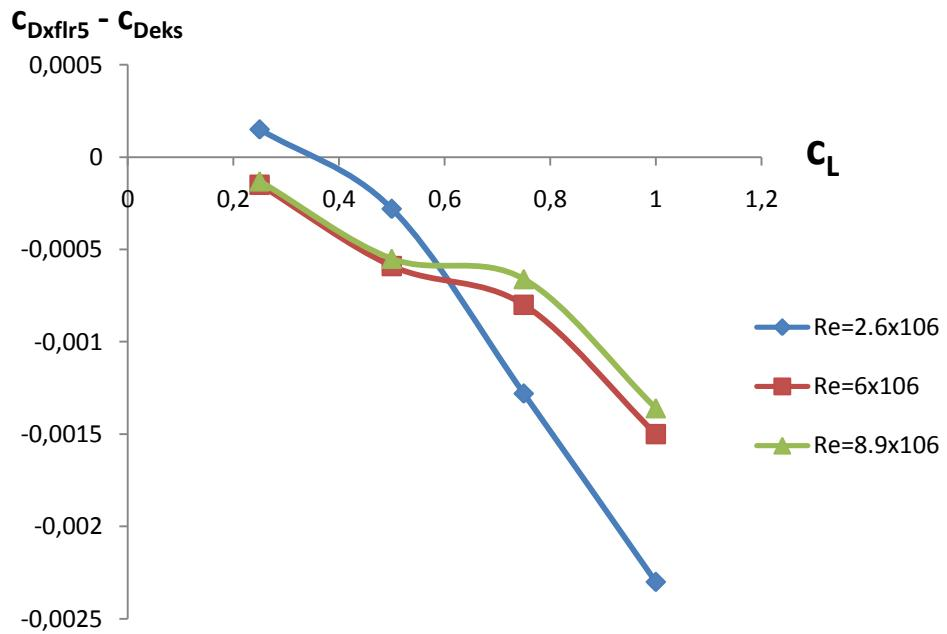
**Slika 2.4.8: Ovisnost absolutne greške izračunatog otpora o koeficijentu uzgona i Reynoldsovom broju ( $n_{crit} = 6$ )**
