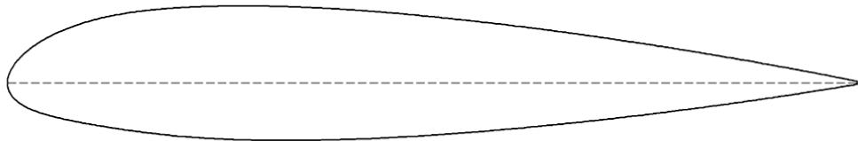
Slika 2.4.1: Aeroprofil NACA 23015
