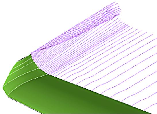
**Slika 7.4.2: Izlazne strujnice krila s wingletom tipa 1**
