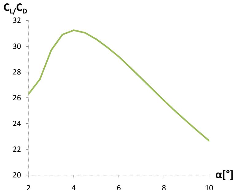
Slika 3.3.5: Ovisnost omjera  $C_L/C_D$  o napadnom kutu za  $v = 42 \text{ m/s}$
