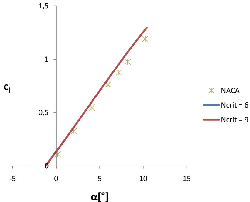
Slika 2.4.4: Usporedba rezultata  $c_l(\alpha)$  za  $Re = 8.9 \times 10^6$
