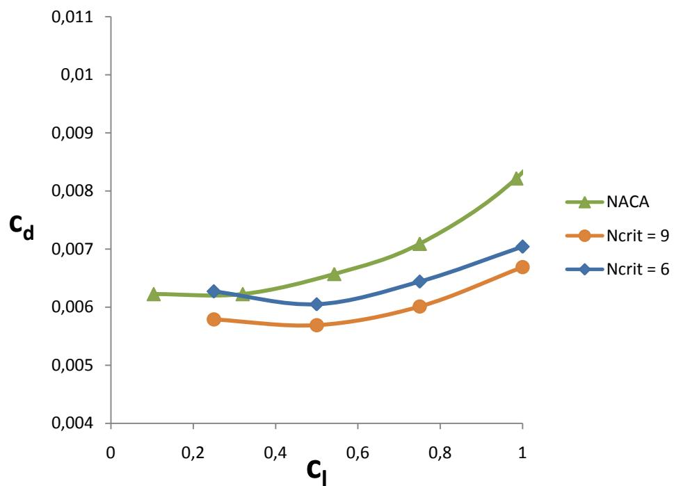
Slika 2.4.6: Usporedba rezultata polare za  $Re = 6 \times 10^6$
