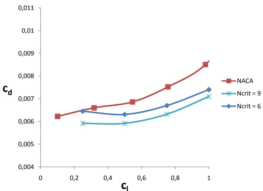
Slika 2.4.7: Usporedba rezultata polare za  $Re = 8.9 \times 10^6$
