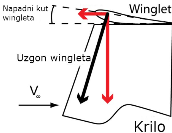
**Slika 6.2.3: Sile koje nastaju zbog uzgona wingleta**
