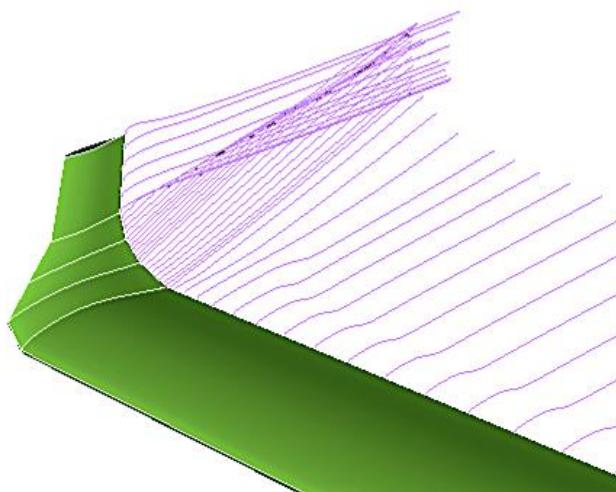
Slika 7.4.4: Izlazne strujnice krila s *wingletom* tipa 2
