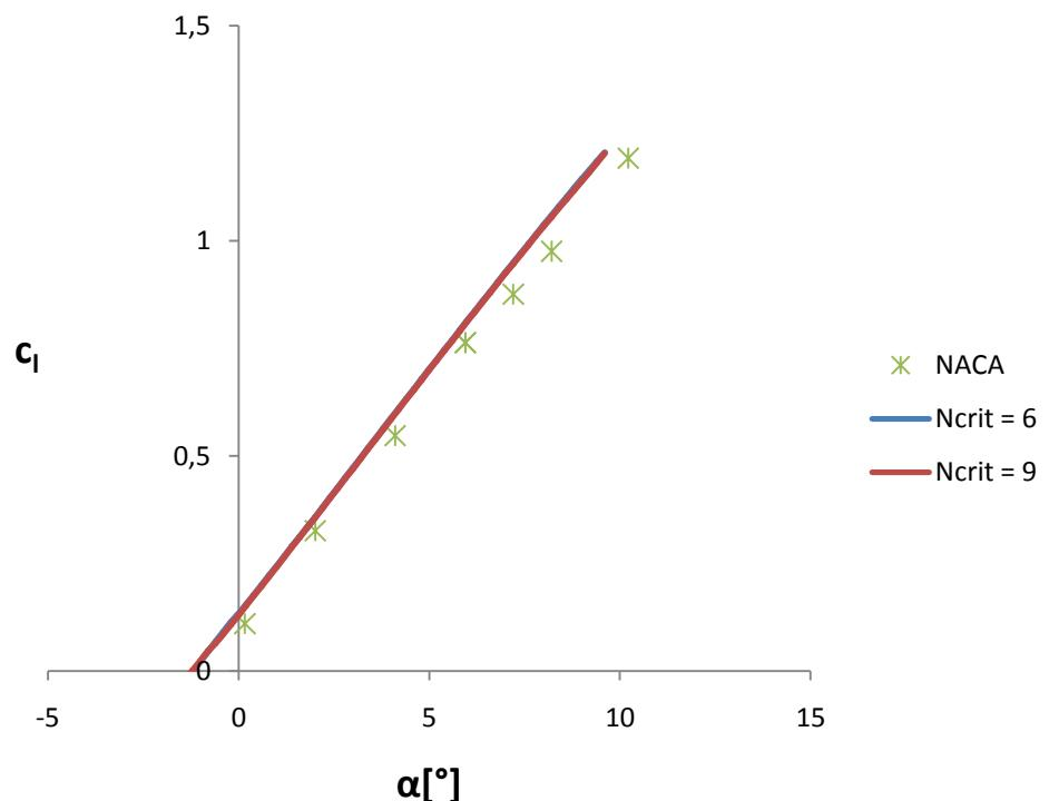
Slika 2.4.3: Usporedba rezultata  $c_l(\alpha)$  za  $Re = 6 \times 10^6$
