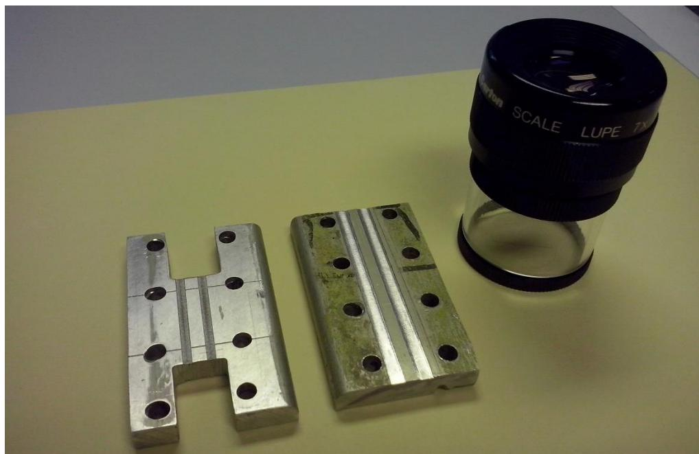
Slika 29. Očitavanje dimenzije širina oštećenja Carton scale povećalom
