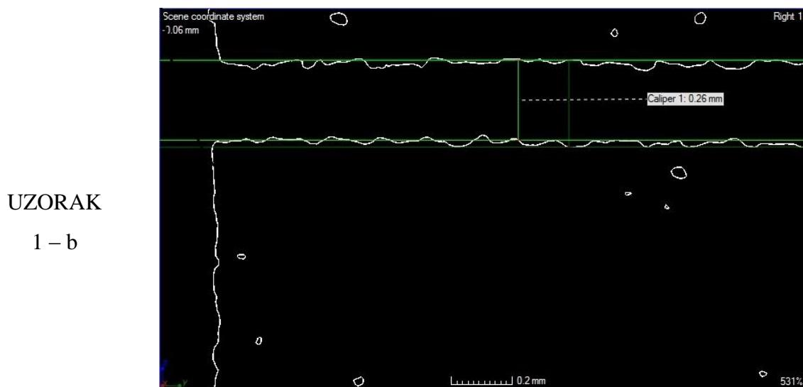
Slika 48. Očitavanje širine oštećenja iz Y-Z ravnine, [mm]
