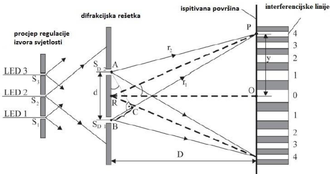
Slika 13. Metoda računanja udaljenosti probe od ispitivane površine [10]
