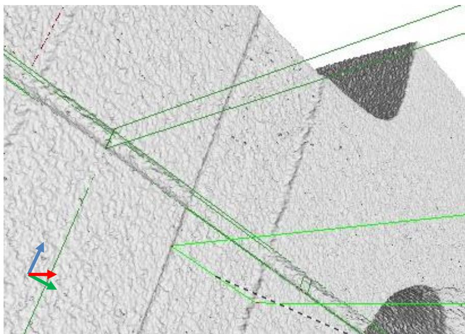
Slika 45. Prikaz rendgenske snimke uzorka i označavanja oštećenja prije očitavanja
