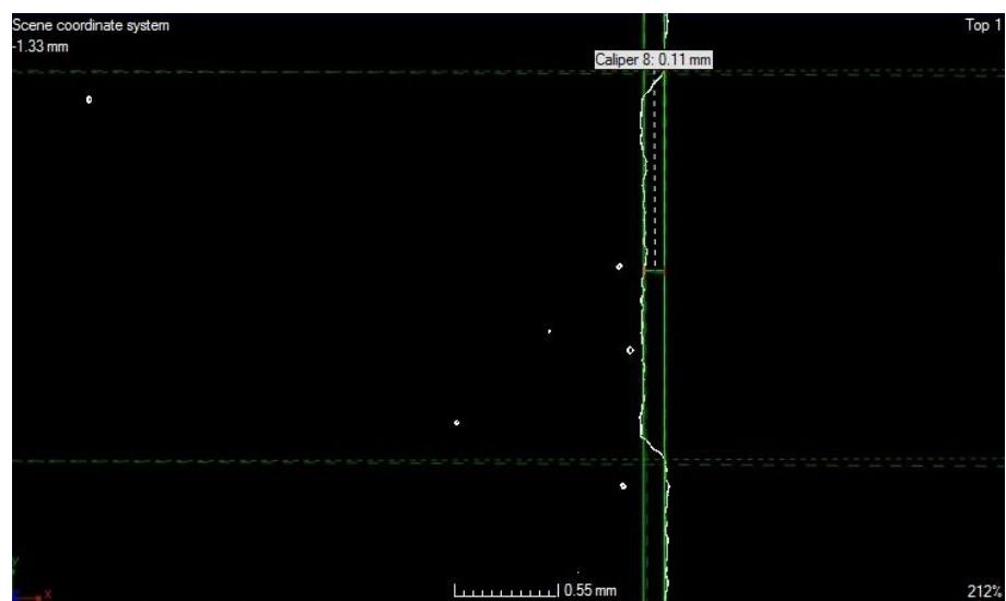
Slika 47. Očitavanje dubine oštećenja iz X-Y ravnine, [mm]
