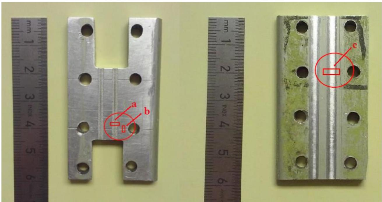
Slika 27. Uzorci 1 i 2 sa oznakama područja a, b, c na kojima se provodi dio ispitivanja (mjerno povećalo, 3D fazno mjerjenje, stereo metoda mjerjenja, računalna tomografija)
