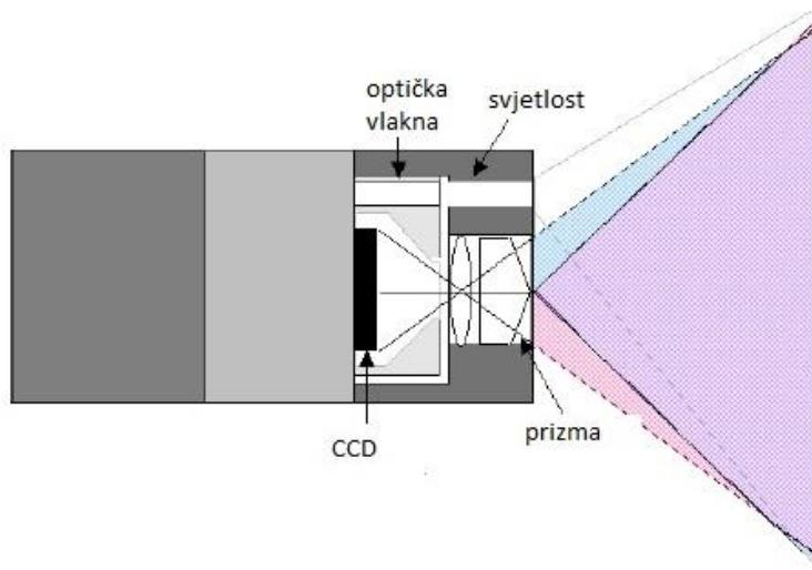
Slika 8. Prikaz principa rada stereo metode mjerena [6]
