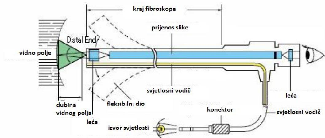
Slika 2. Presjek fibroskopa [4]
