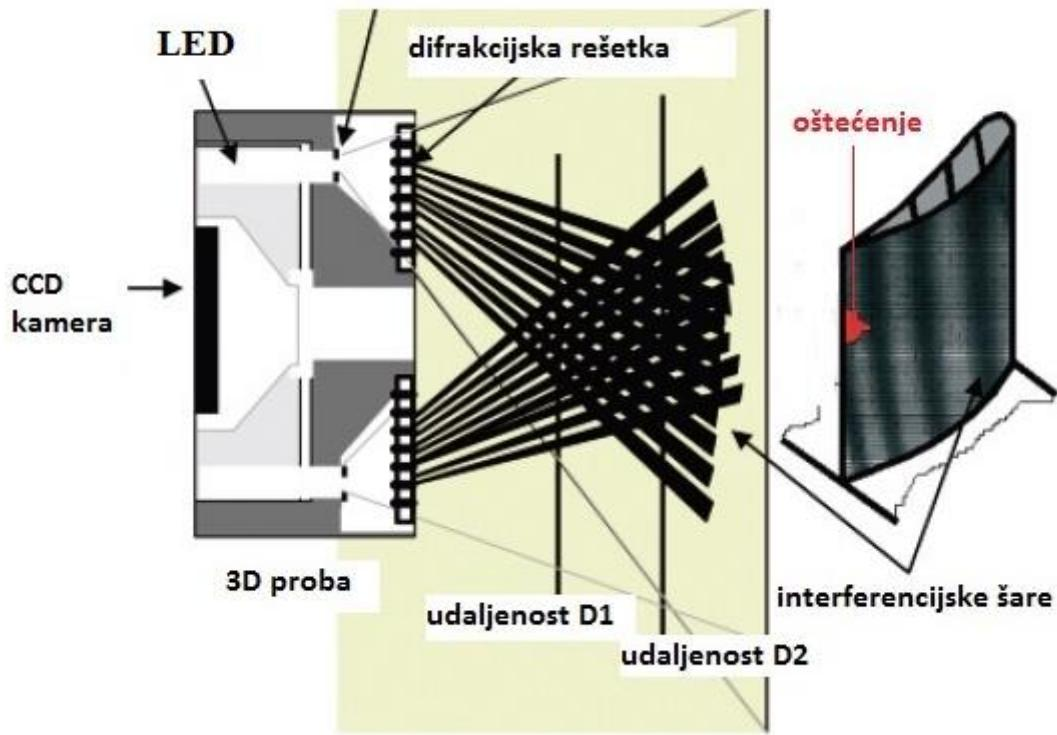
Slika 12. Shema projiciranja interferencijskih linija pomoću rešetkastog uzorka za 3D fazno mjerjenje [10]
