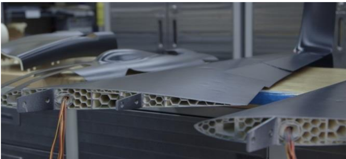
Slika 8 Krilo bespilotne letjelice Aurora Flight Sciences [8]
