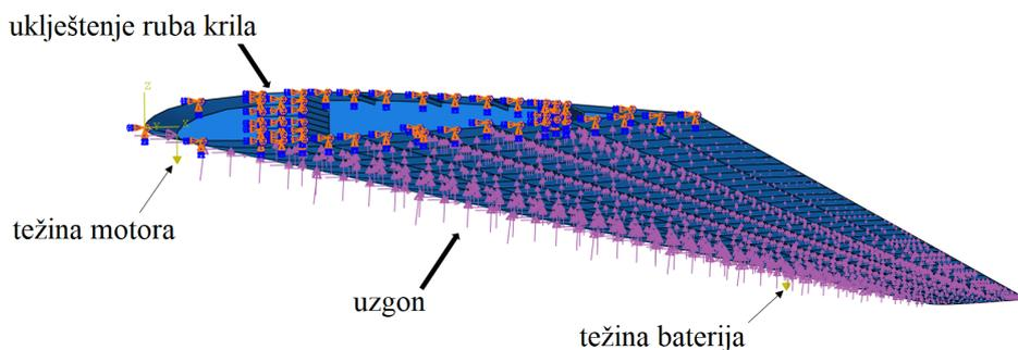
Slika 4.5: Uklještenje, opterećenje uzgona, motora i baterija
