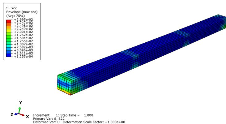
Slika 5.17: Naprezanje u baterijama u osi  $Y$  [MPa]
