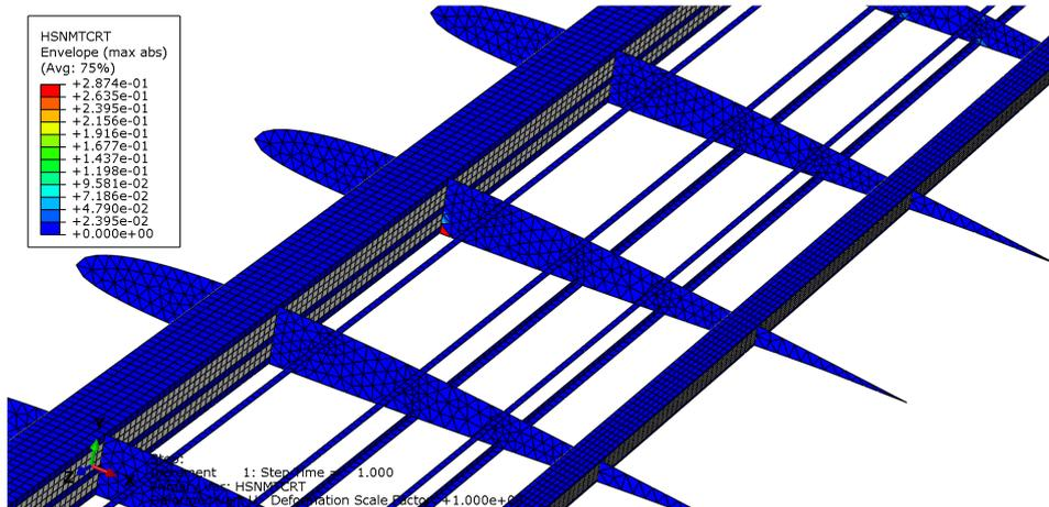
Slika 5.10: Vrijednosti Hashin kriterija za popuštanje matrice uslijed vlačnog opterećenja krila s eksternim baterijama
