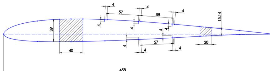
Slika 2.3: Dimenzije ramenjača i uzdužnica u presjeku vrha krila u [mm]
