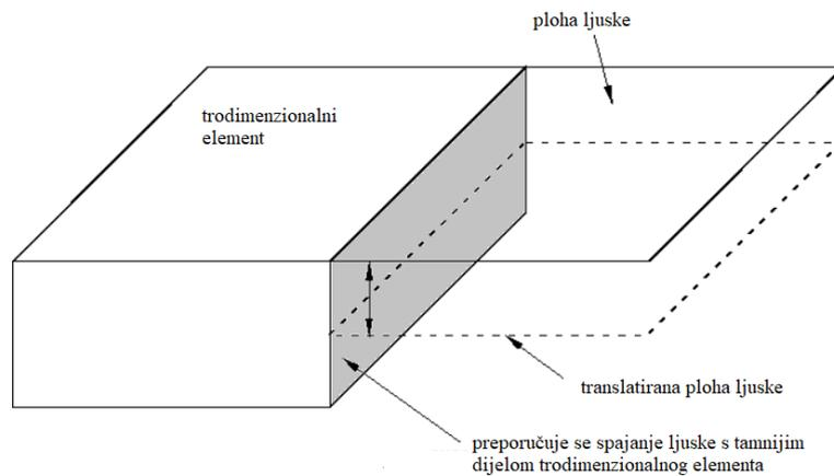
Slika 4.3: Spajanje trodimenzionalnog i dvodimenzionalnog elementa [29]
