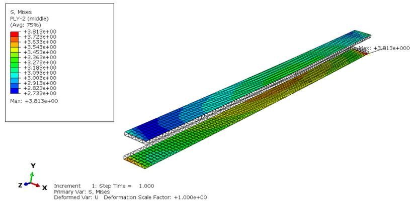
Slika 5.18: Naprežanje po Von Misesu zaštitnog sloja baterija krila s integriranim baterijama [MPa]
