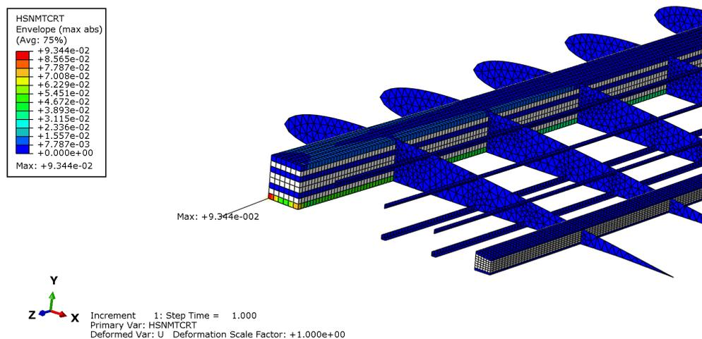
Slika 5.21: Vrijednosti Hashin kriterija za popuštanje matrice uslijed vlačnog opterećenja krila s integriranim baterijama
