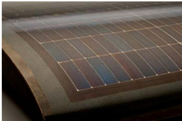
Slika 2.10: Solarne ćelije AltaDevices ugrađene direktno na CFRP [16]
