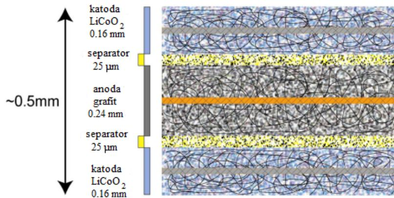
Slika 2.12: Shematski prikaz slojeva *Telecordia* Litij-polimer baterija [19]
