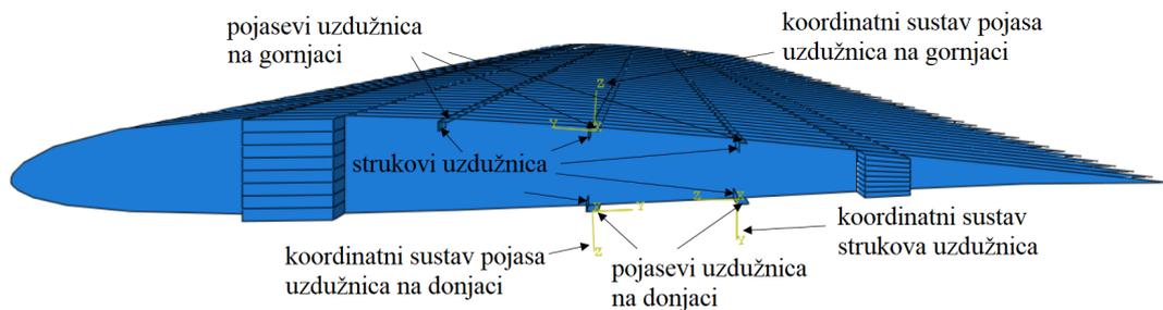
Slika 4.9: Dijelovi uzdužnica i lokalni koordinatni sustavi
