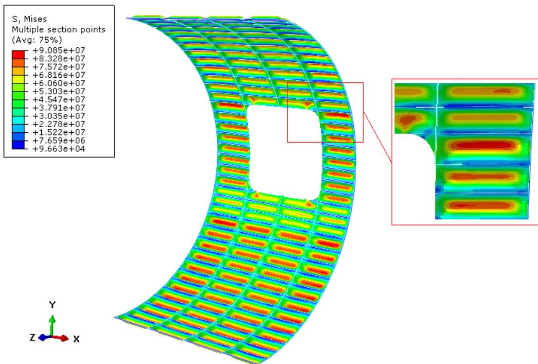
Slika 36. Raspodjela naprezanja prema von Misesu [Pa]
