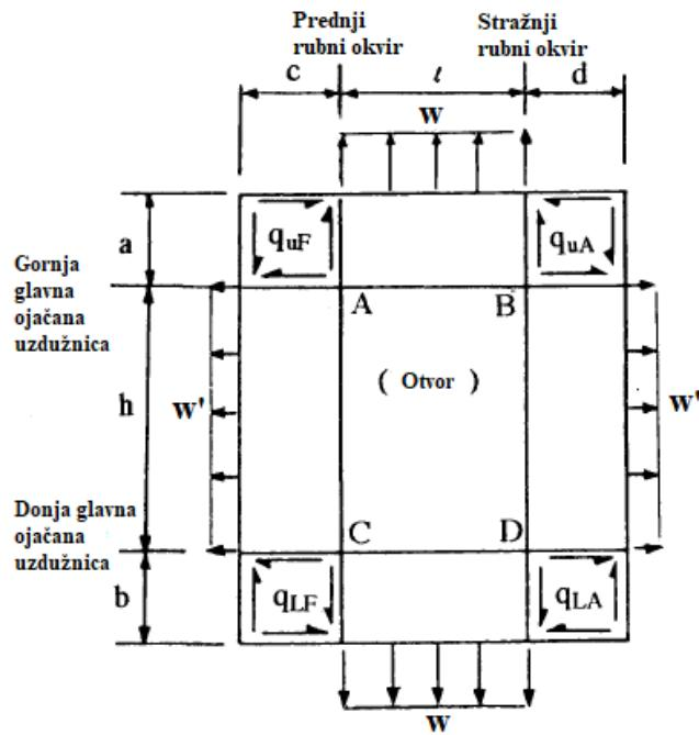
Slika 12. Tokovi smičnih naprezanja u kutnim panelima [3]
