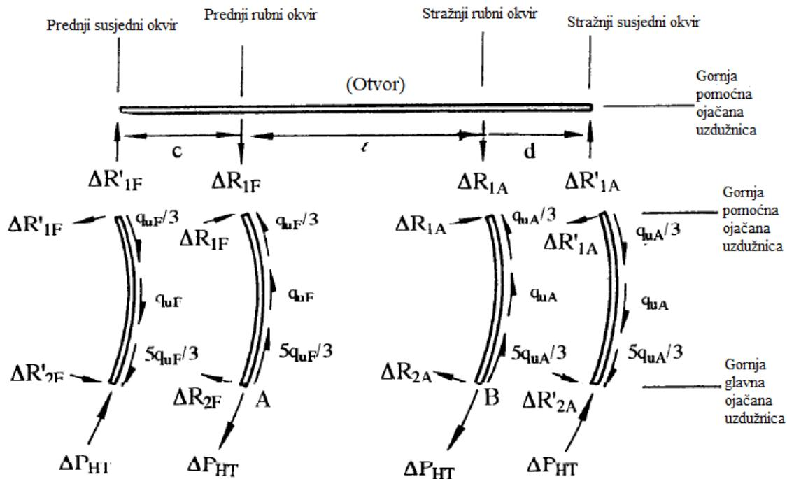
**Slika 17. Inducirane radikalne sile okvira i ojačanih uzdužnica nastalih zbog kutnih tokova posmičnih naprezanja ( $q_{uF}$  i  $q_{uA}$ ) [3]**
