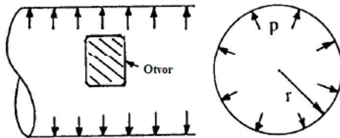
Slika 9. Prikaz opterećenja pri prešurizaciji kabine [3]
