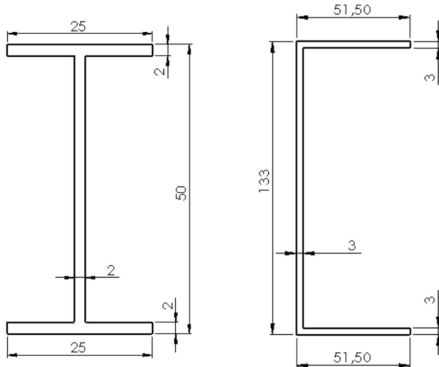
Slika 31. Poprečni presjek profila uzdužnica (lijevo) i okvira (desno) [mm]
