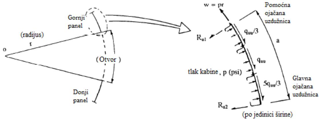
**Slika 14. Izjednačavanje sile na gornjem panelu otvora (jedinični tlak kabine = 1.0 psi) [3]**
