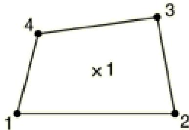
**Slika 25. Četverkoutni element S4R [5]**
