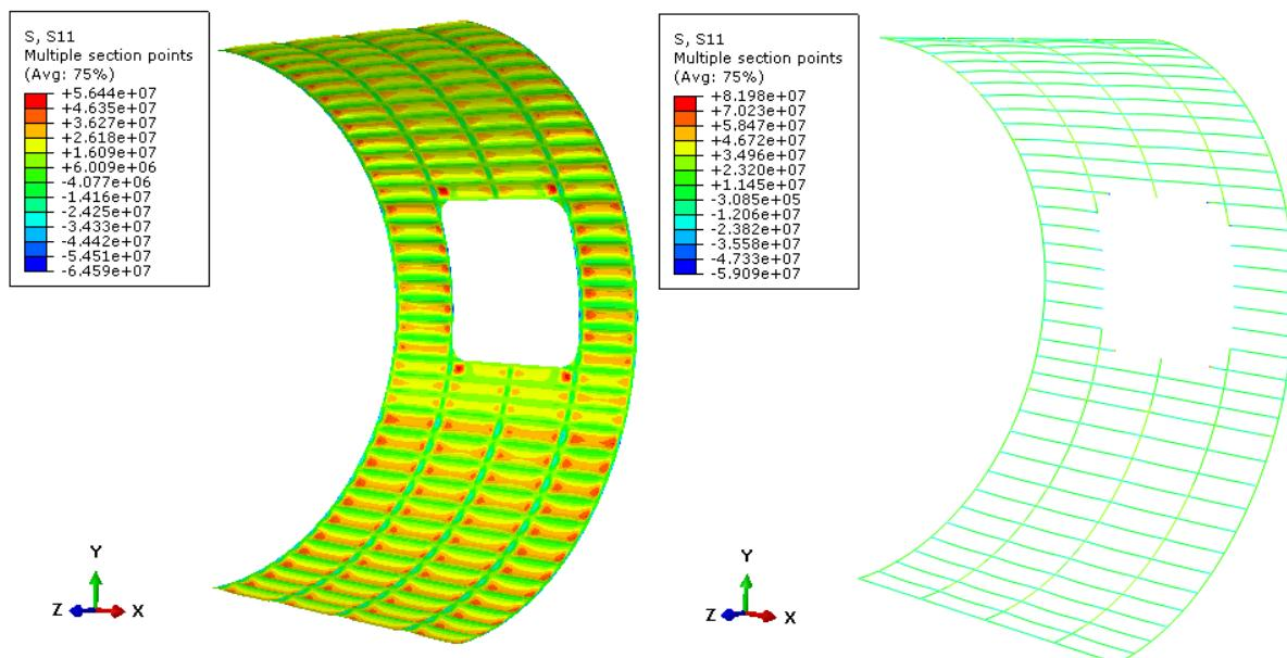
**Slika 38. Raspodjela meridijanskog naprezanja u samo ljkuskastim elementima (lijevo) i grednim elementima (desno) [Pa]**
