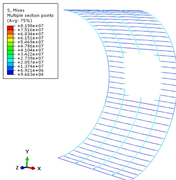
Slika 37. Raspodjela ekvivalentnih von Mises naprezanja [Pa] u grednim elementima
