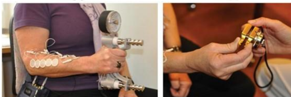
Slika 62. Dodatni senzori za procjenu sila mišića podlaktice [22], [23]
