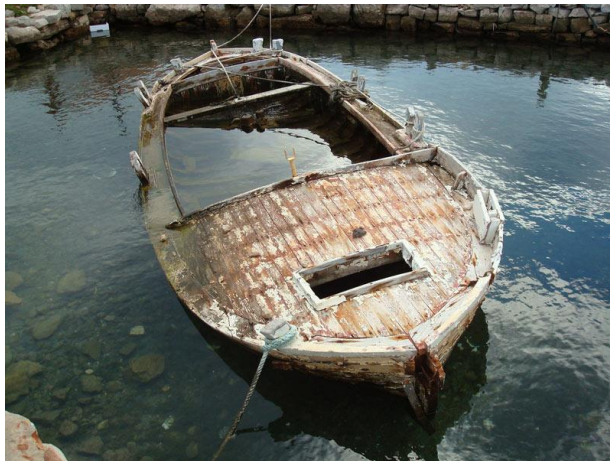
Slika 17: Istrunulo drveno plovilo.
