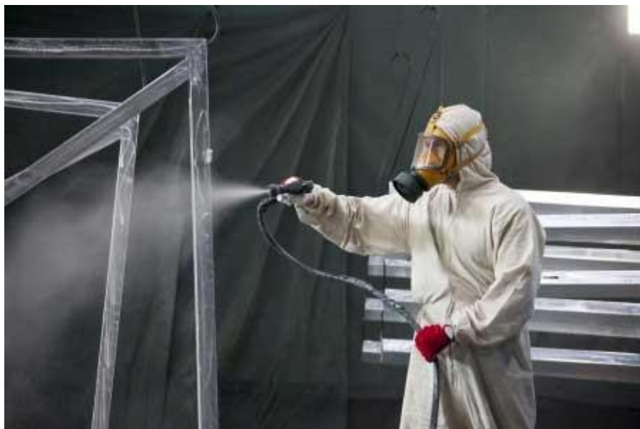
Slika 16 Raspršivanje cinka, jedan od postupaka nanošenja cinkove prevlake na površinu čelika [16]
