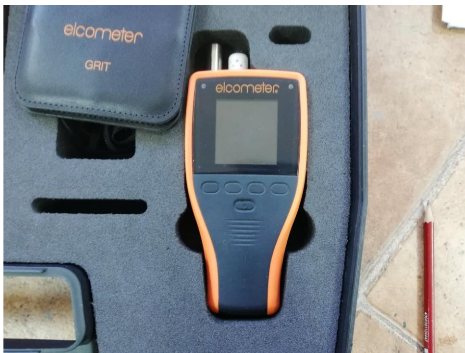
Slika 27 Elcometer 456, uređaj za mjerenje debljine sloja zaštitne prevlake
