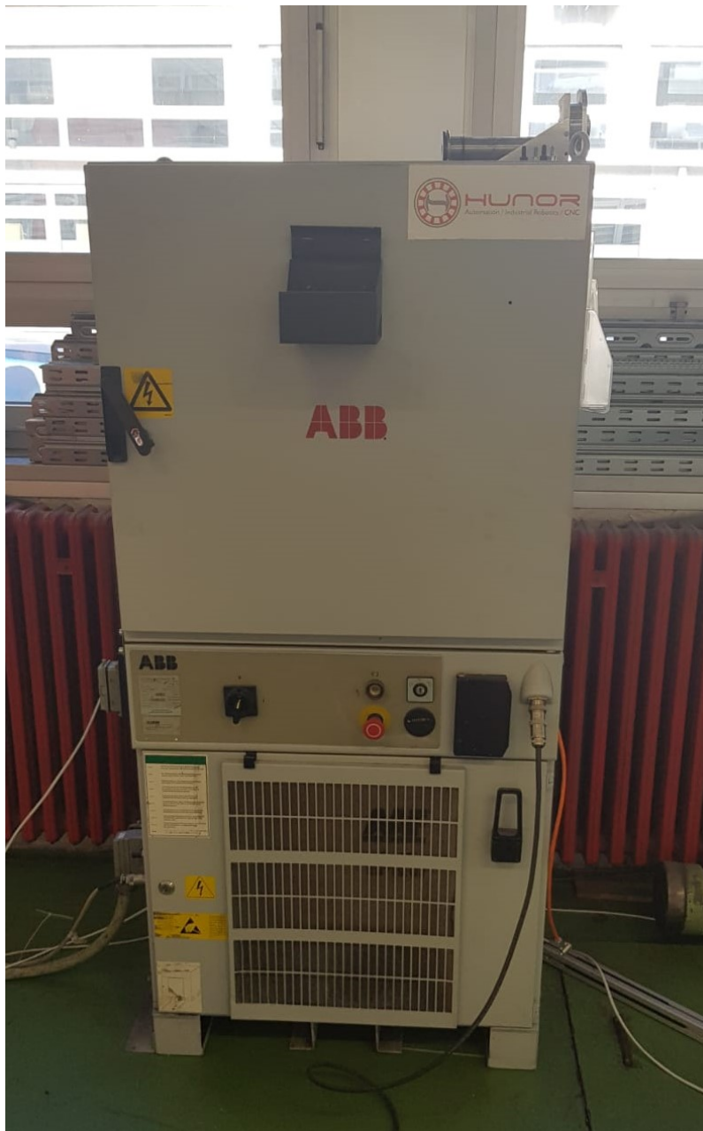
Slika 10. S4C upravljačko računalo iz Laboratorija za alatne strojeve
