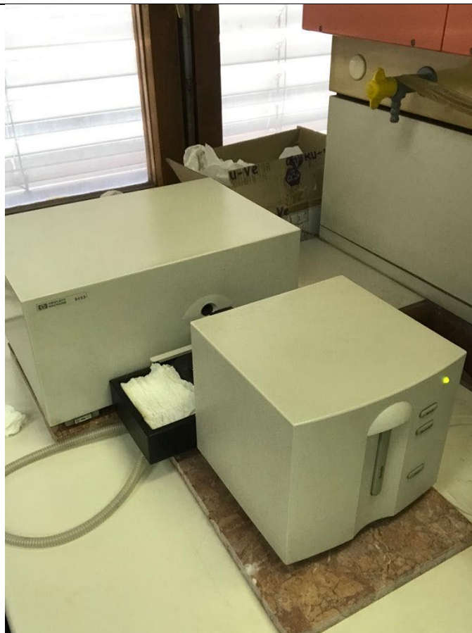
Slika 6. Spektrofotometar Hewlett Packard, model 8453 (Hewlett Packard, SAD)
