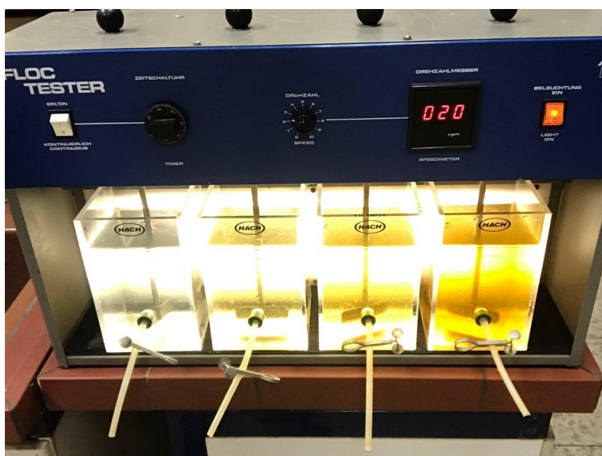
Slika 7. Aqualytic Floc Tester (Model AMF 4, Njemačka)
