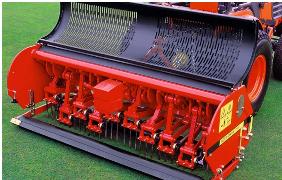
Slika 17. Unutrašnjost prozračivača Verti-Drain 2220 [19]
