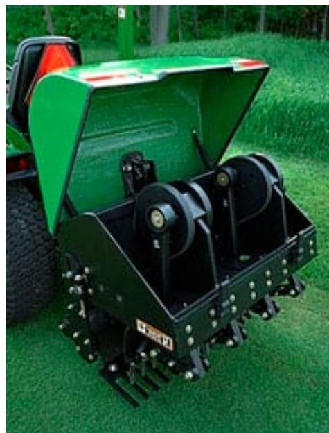
Slika 24. Transformacija rotacijskog gibanja u linearno – John Deere [22]
