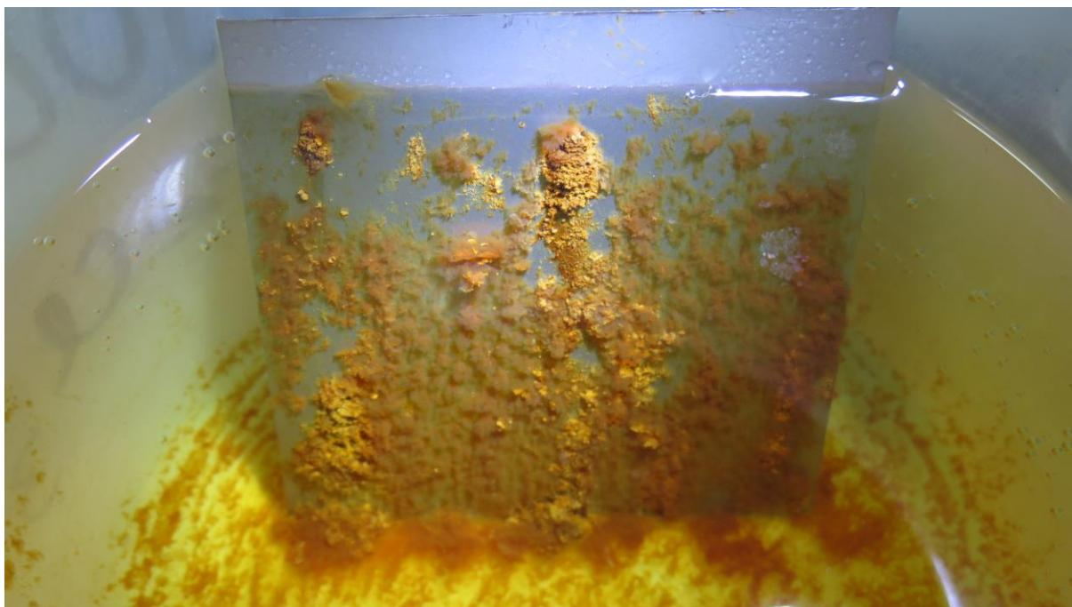
Slika 38. Detaljniji prikaz korozijskih produkata na čeliku AISI 304L
