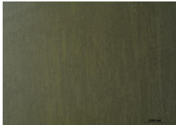
Slika 50. Neoštećena površina uzorka čelika AISI 316L nakon 192 h ispitivanja u 3,5 % otopini NaCl
