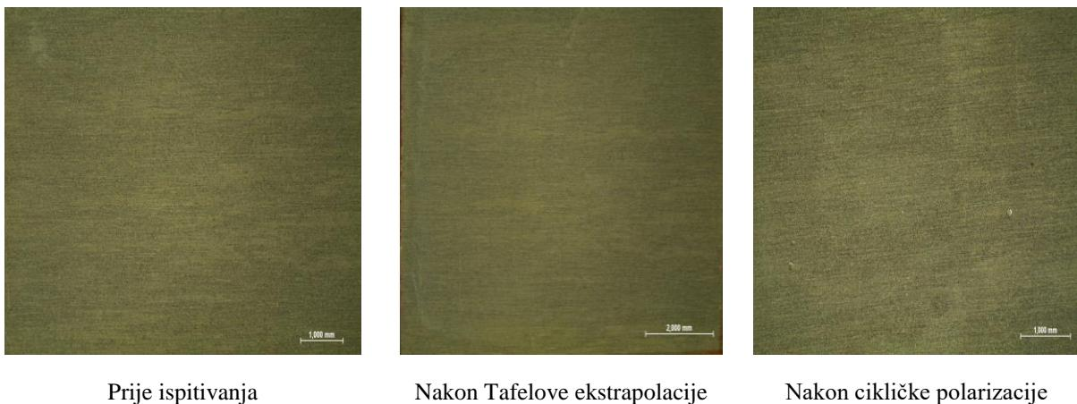
**Slika 65.** Stereomikroskopske snimke površine uzorka čelika AISI 316L tijekom elektrokemijskih ispitivanja u 3,5 % otopini NaCl
