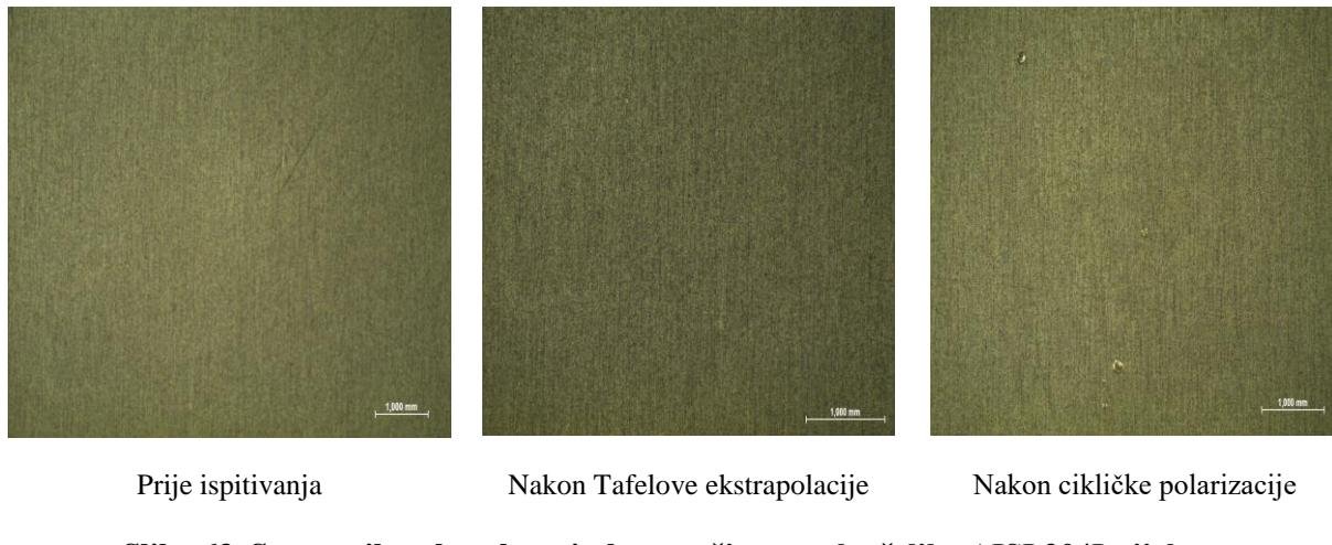
**Slika 63. Stereomikroskopske snimke površine uzorka čelika AISI 304L tijekom elektrokemijskih ispitivanja u 3,5 % otopini NaCl**
