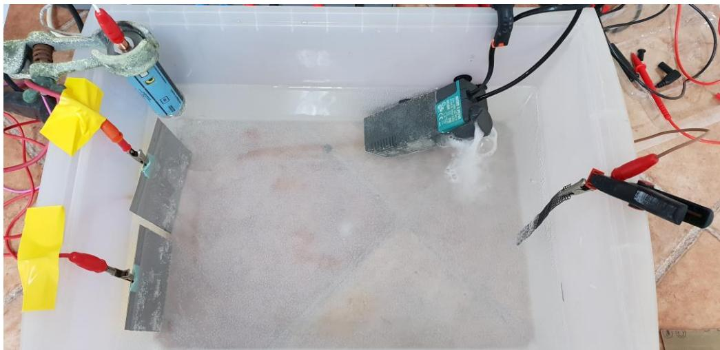
**Slika 31. Detaljniji prikaz provedbe ispitivanja s katodnom zaštitom uzorka**
