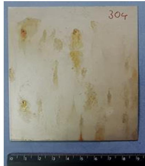
Nakon uklanjanja korozijskih produkata
