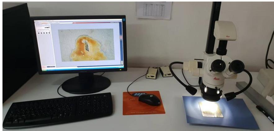
Slika 44. Stereomikroskop Leica MZ6
