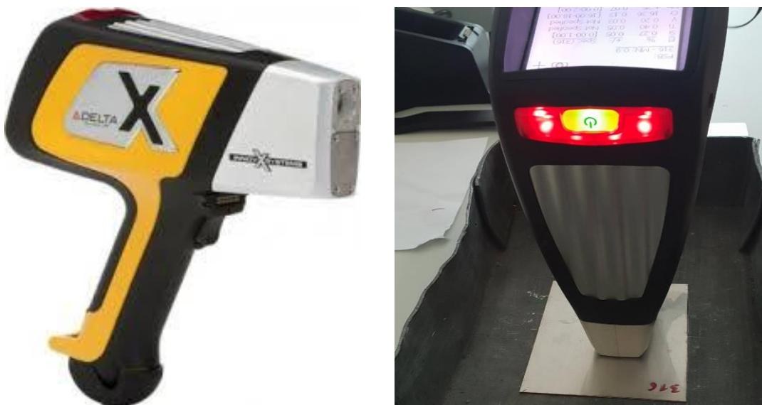
Slika 29. Uredaj XRF – Olympus i prikaz provedbe ispitivanja na čeliku AISI 316 L
