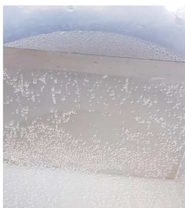
Slika 36. Napredovanje korozije čelika AISI 304L u 3,5 % otopini NaCl s dodatkom H 2 O 2
