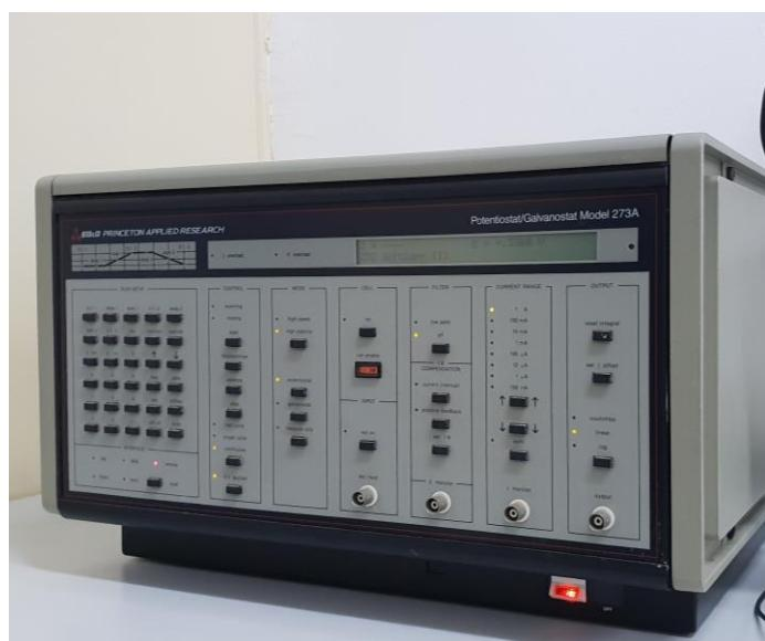
**Slika 54. Potencijostat EG&G PRINCETON APPLIED RESEARCH Model 273A korišten za elektrokemijska ispitivanja**
