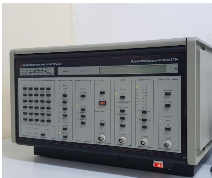
Slika 54. Potencioštat EG&G PRINCETON APPLIED RESEARCH Model 273A korišten za elektrokemijska ispitivanja
