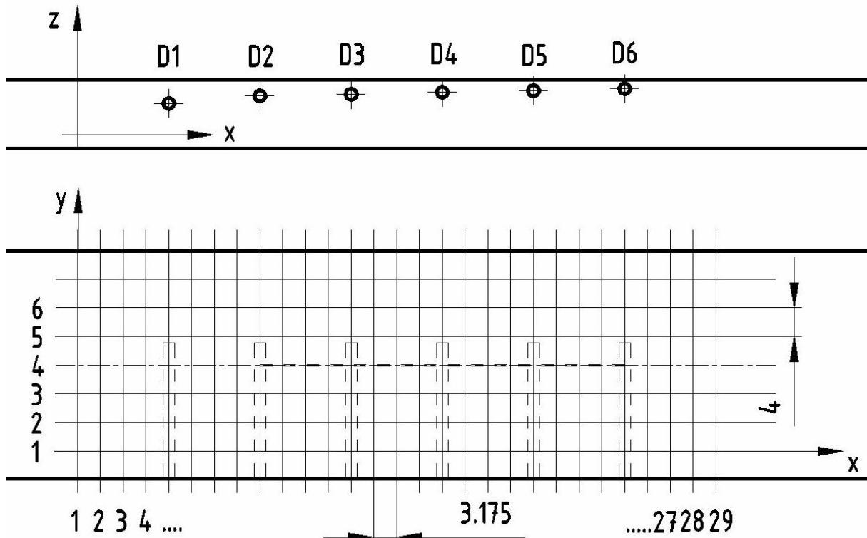
Slika 4.3. Raster na površini etalona Test Bar-a
