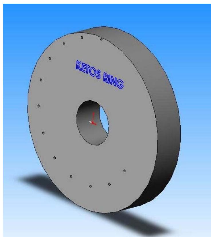
Slika 2.2. CAD model radnog etalona Ketos Ring
