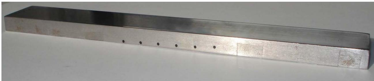
Slika 2.3. Izrađeni etalon Test Bar
