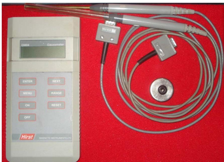
Slika 3.4. Uređaj za mjerjenje jakosti magnetskog polja
