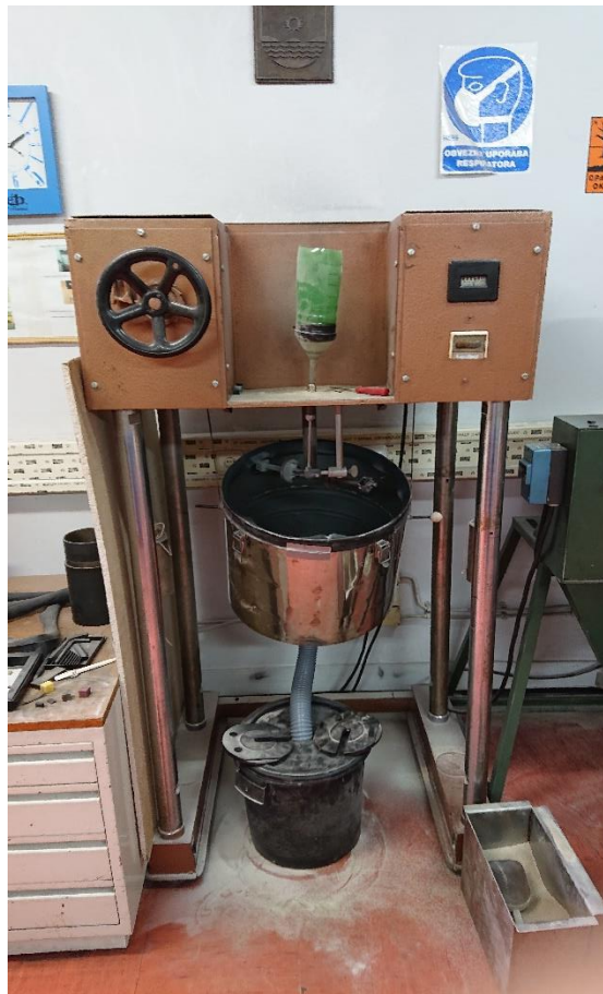
Slika 37. Uređaj za ispitivanje otpornosti na erozijsko trošenje
