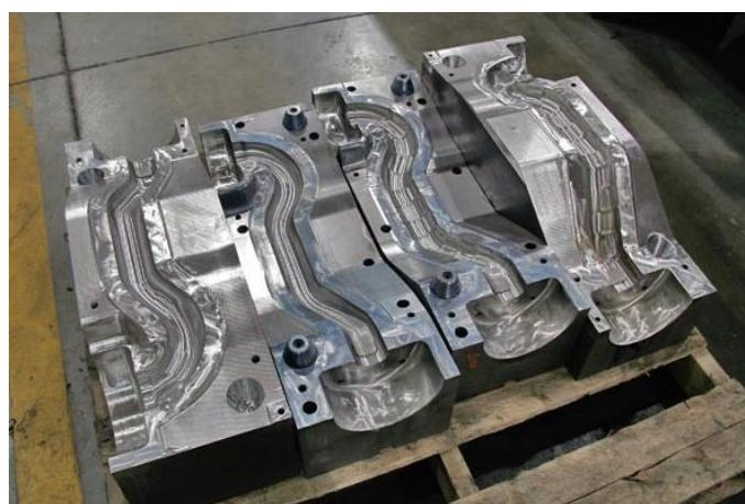
**Slika 48. Kalup za hidrooblikovanje ispušnih komponenti automobilista [39]**
