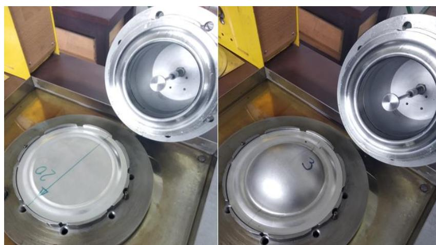
Slika 54. Rondela prije i nakon hidrauličkog udubljivanja
