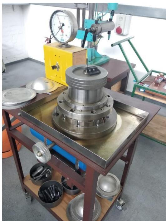
Slika 53. Naprava za hidrauličko udubljivanje
