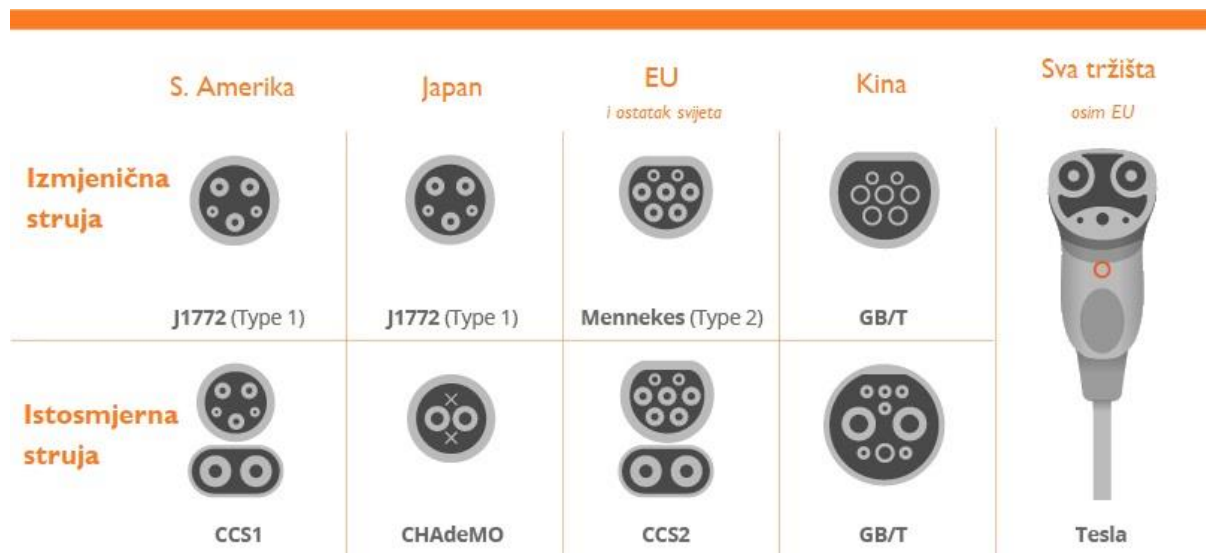
Slika 9. Priklučci na električnim vozilima prema IEEE standardima [38]
