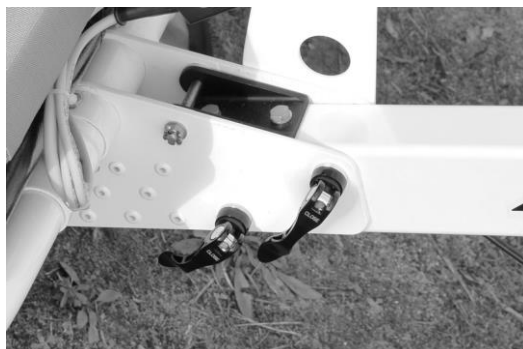
Slika 24. Zglob na ANT kolicima [9]
