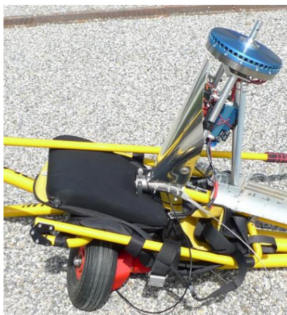
Slika 25. Zglob za sklapanje okvira nosača sjedala [7]
