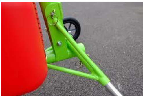
Slika 26. Zglob Snake kolica [12]
