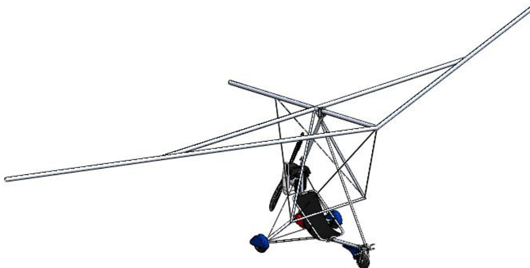
Slika 28. Koncept mikrolake ovjesne jedrilice
