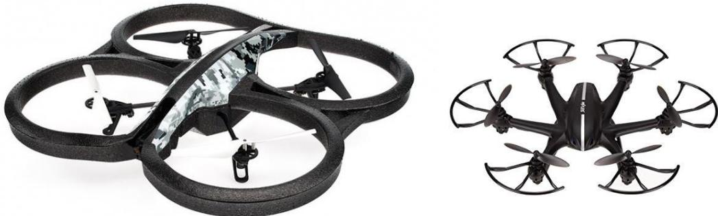
Slika 3.1. Bespilotne multi-rotorske letjelice;
