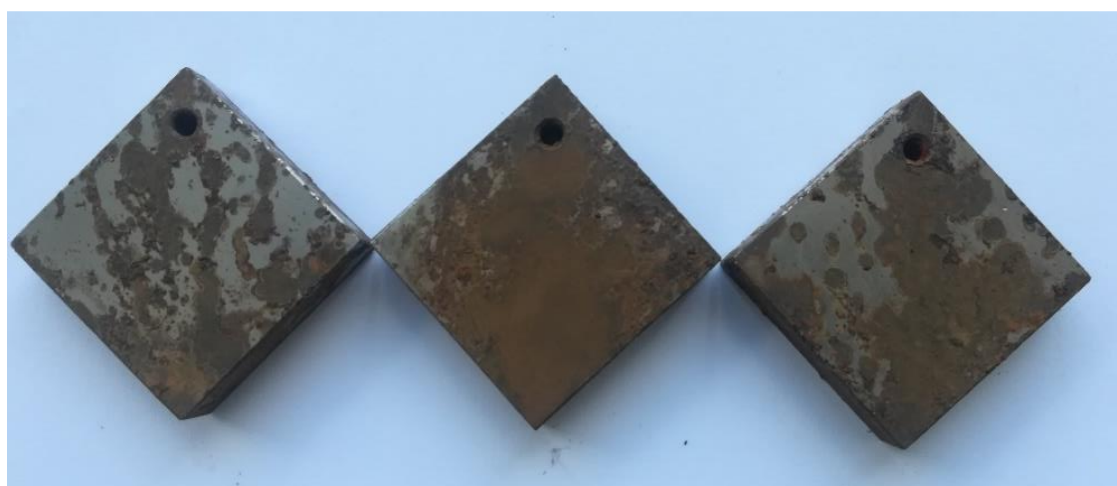
Slika 37. Uzorci nakon ispitivanja u morskoj vodi
