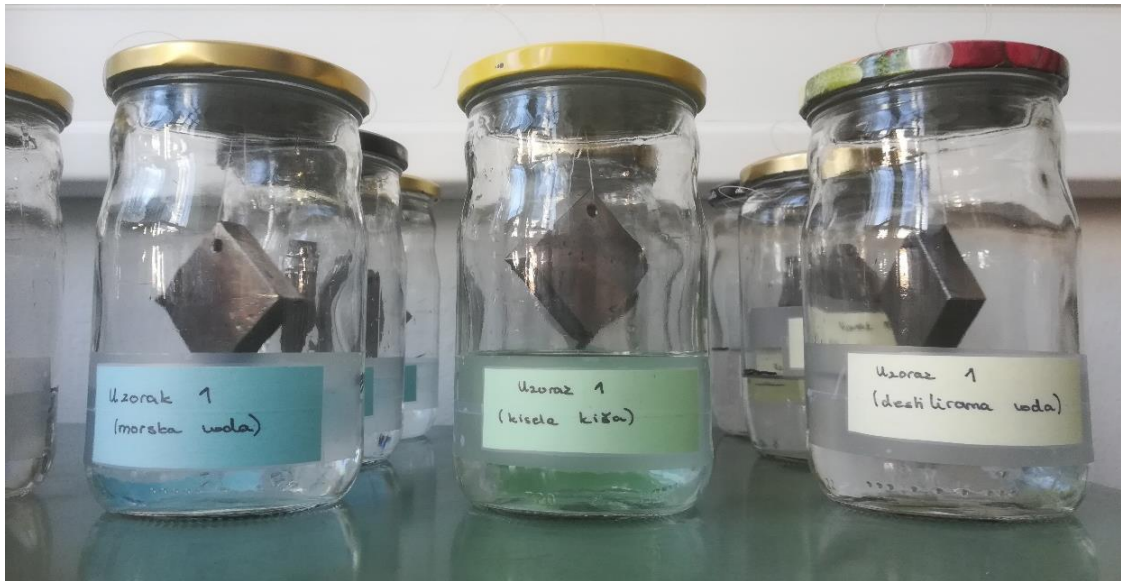
Slika 20. Ispitni uzorci u posudama
