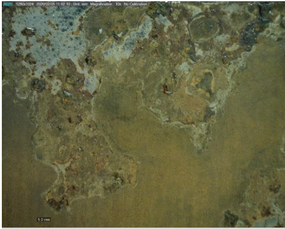
Slika 38. Površina uzorka nakon ispitivanja u morskoj vodi
