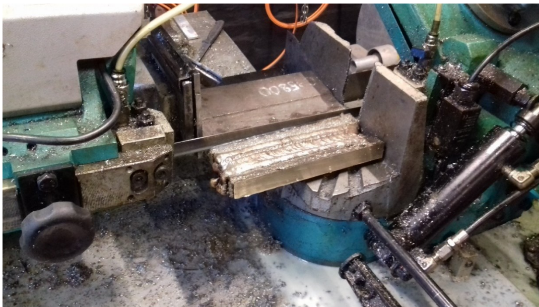
Slika 26. Rezanje ploča na tračnoj pili
