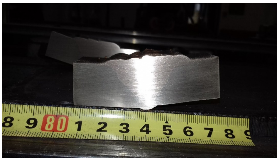
Slika 27. Makroizbrusci nakon brušenja i čišćenja
