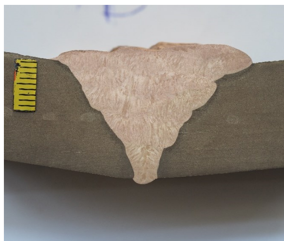
Slika 29. Makroizbrusak uzorka B
