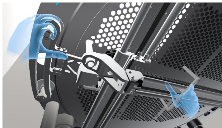
Slika 97. Inicijalno zatezanje konusnih matica
