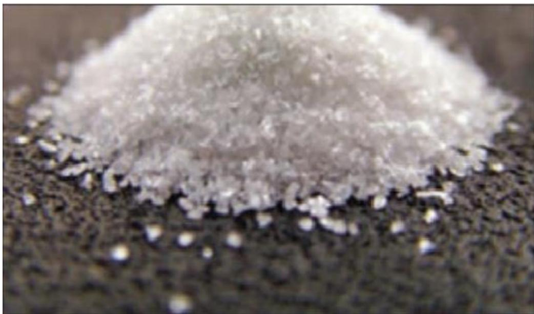
Slika 12. Korund (mineral s više od 98 %  $\text{Al}_2\text{O}_3$ ) [10]
