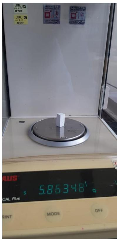
**Slika 25. Mjerenje mase uzorka**
