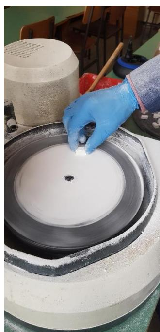
**Slika 22. Brušenje uzorka**
