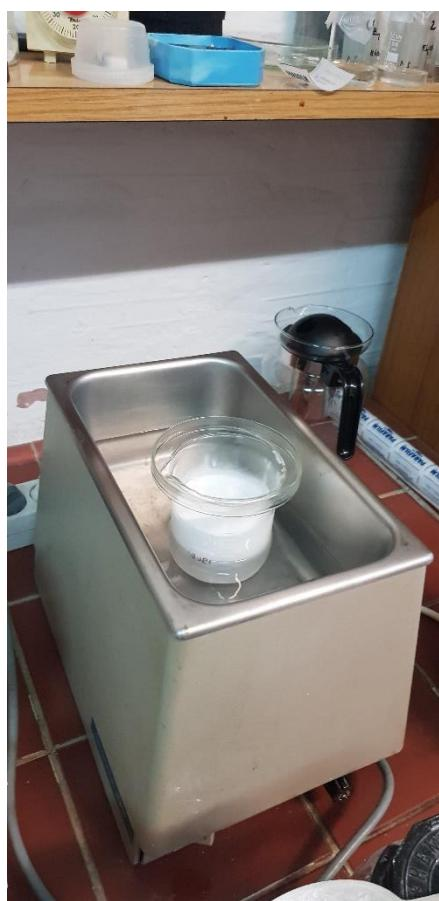
Slika 18. Ultrazvučna kupelj
