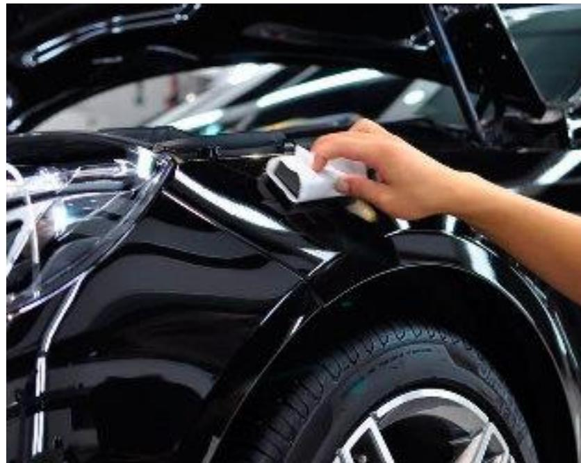
Slika 1. Primjena keramike u automobilskoj industriji – keramički zaštitni premaz [4]
