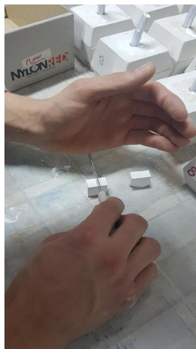
Slika 21. Rezanje uzorka u zelenom stanju
