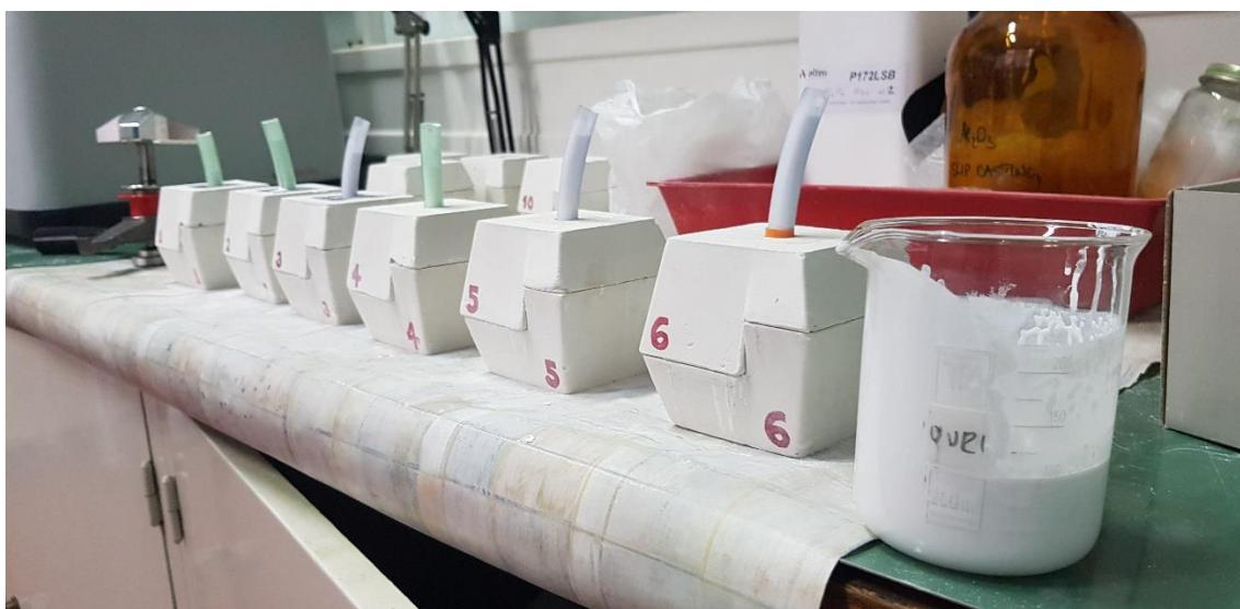
Slika 19. Kalupi nakon lijevanja
