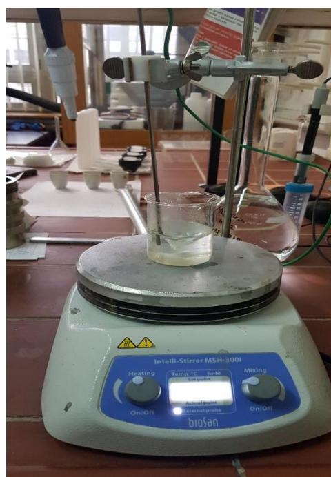
Slika 16. Grijajuća ploča s magnetskim poljem „Intelli-Stirrer MSH-300i“
