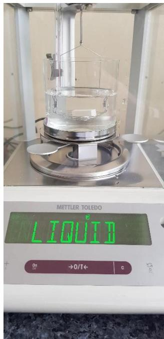
**Slika 29. Mjerenje mase uzorka u mediju**
