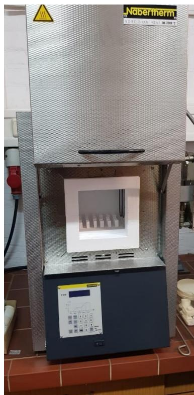
Slika 26. Električna peć za sinteriranje Nabertherm P310
