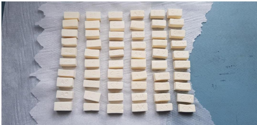
Slika 27. Sinterirani uzorci
