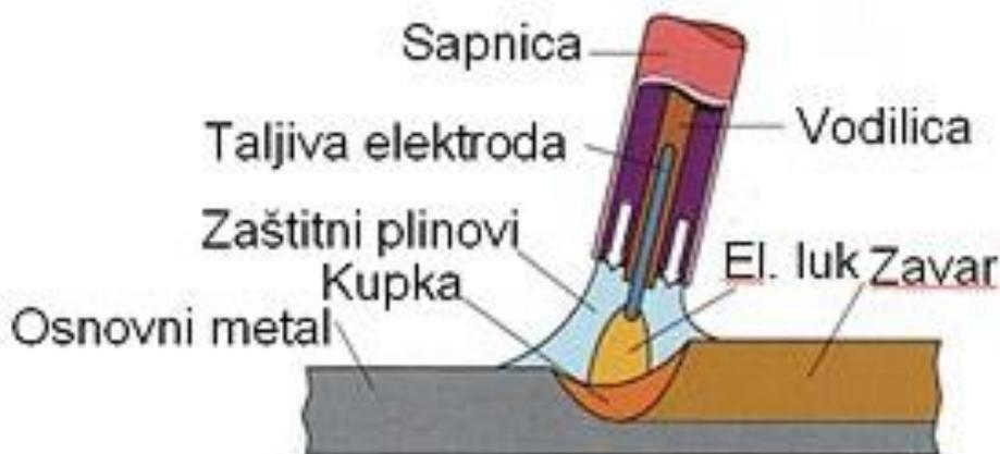
Slika 1. Prikaz električnog luka u MAG postupku zavarivanja [5]
