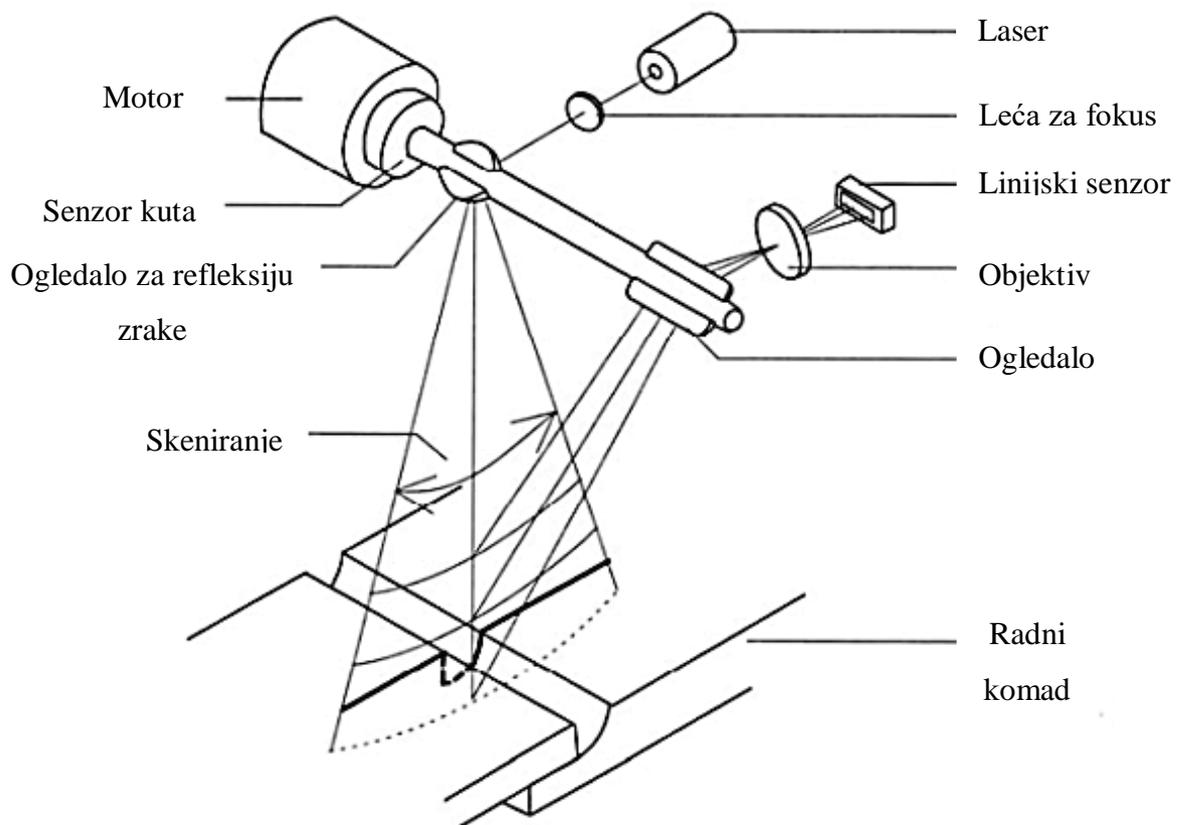
Slika 11. Metoda praćenja spoja kod zavarivanja [19]
