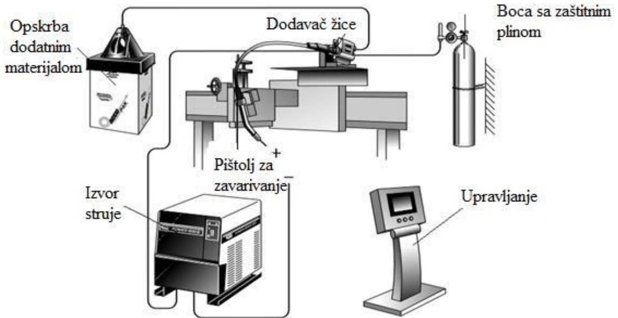
**Slika 3. Automatizirani MAG postupak zavarivanja [7]**
