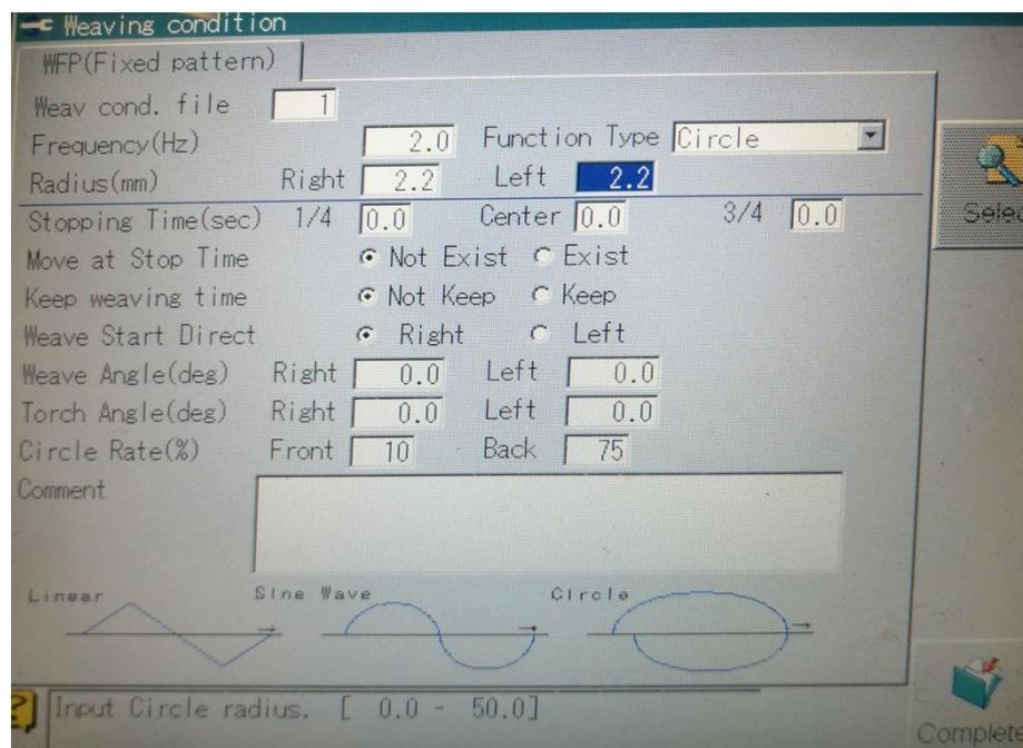
Slika 39. Parametri zavara 2
