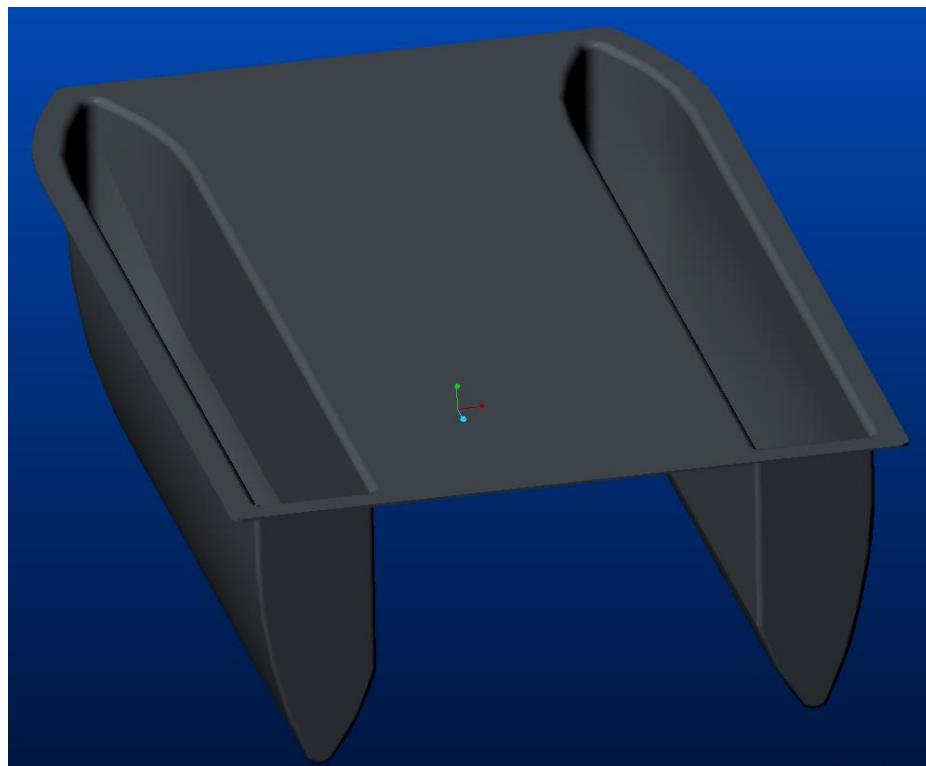
Slika 28. Ljkasta konstrukcija trupa uređaja za čišćenje
