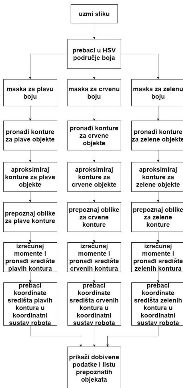
Slika 140. Proces prepoznavanja boje i oblika objekta
