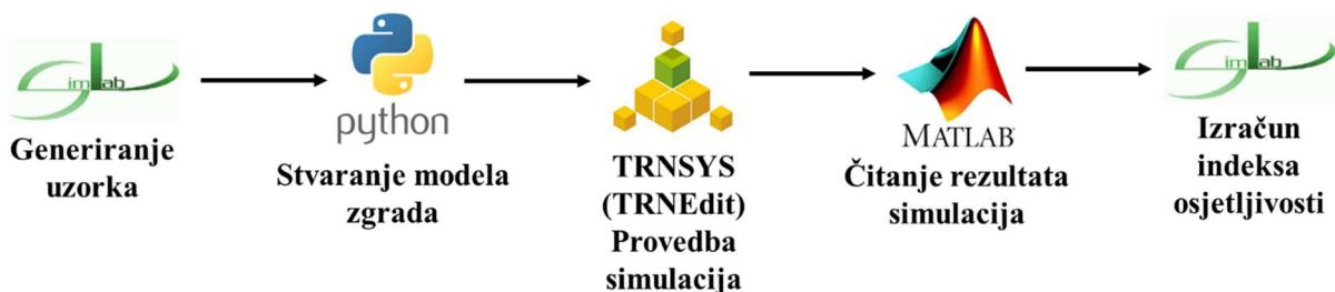
Slika 16. Shema automatizacije provođenja analize osjetljivosti
