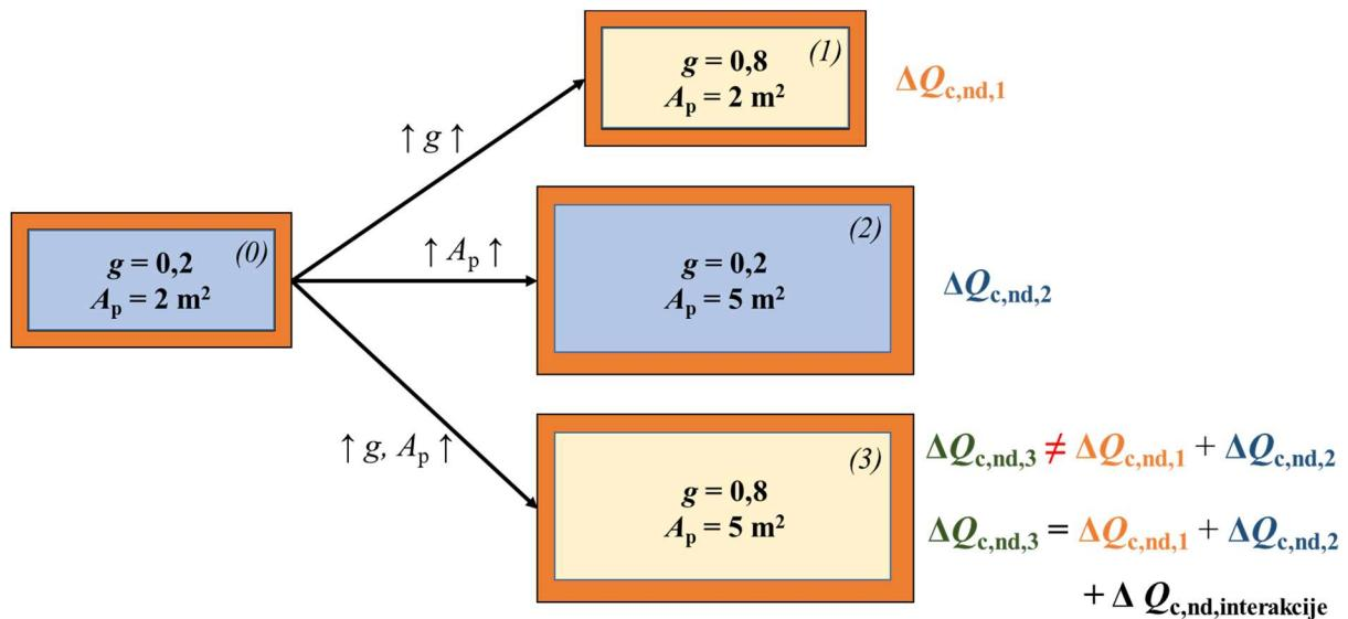
Slika 47. Primjer utjecaja interakcija za promjenu vrijednosti stupnja propuštanja Sunčevog zračenja i površine prozora
