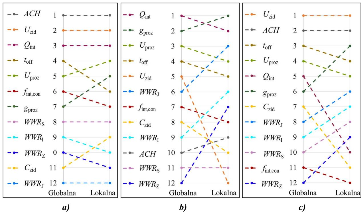
Slika 49. Usporedba rangiranja ulaznih varijabli lokalnom i globalnom metodom po utjecaju na potrebnu energiju za a) grijanje, b) hlađenje, c) grijanje i hlađenje
