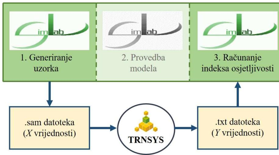
Slika 15. Shema provedbe vanjskog modela u TRNSYS-u
