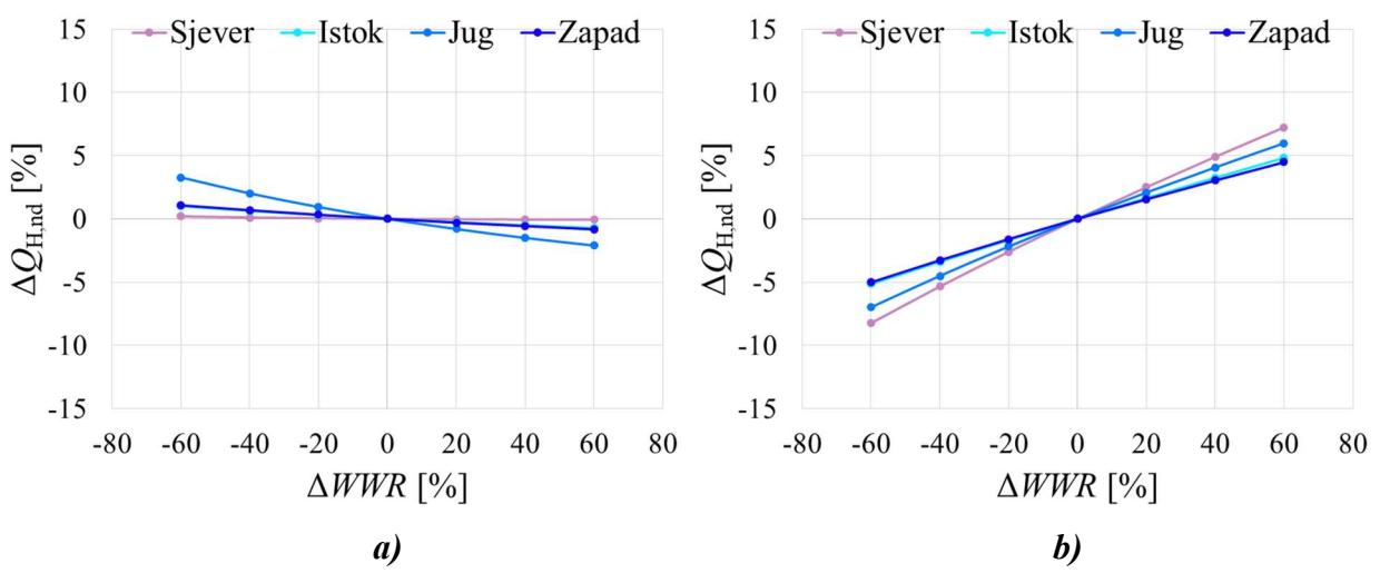
Slika 22. Utjecaj promjene vrijednosti udjela površine prozora u fasadi na potrebnu energiju za grijanje kod prozora s a)  $U_{\text{zid}} = 0,9 \text{ W}/(\text{m}^2 \text{ K})$ ;  $U_{\text{proz}} = 0,84 \text{ W}/(\text{m}^2 \text{ K})$ ;  $g_{\text{proz}} = 0,65$
