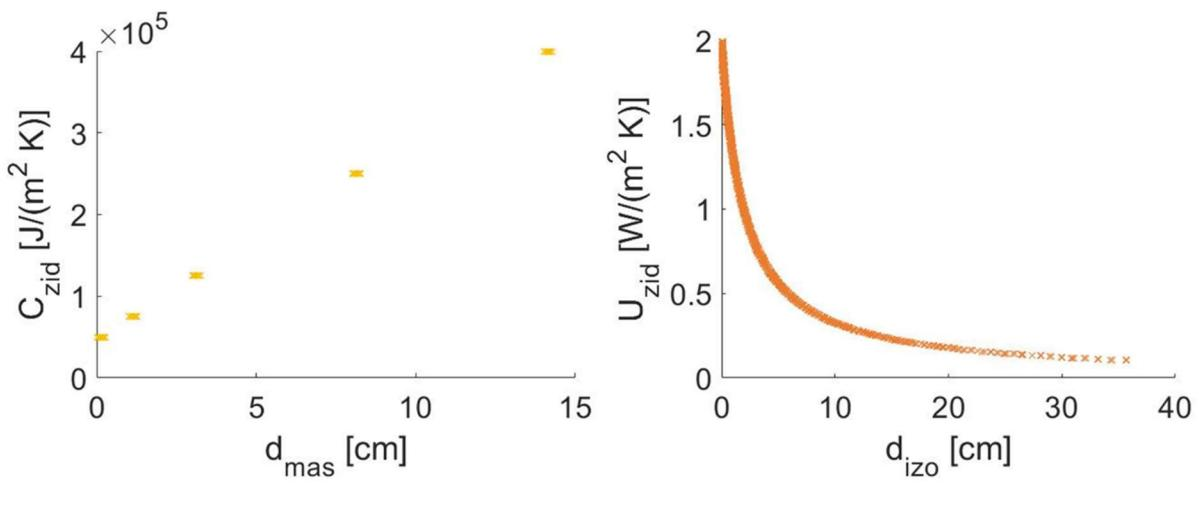
Slika 17. Ovisnost a) toplinskog kapaciteta zida o debljini masivnog sloja, b) koeficijentu prolaza topline zida o debljini izolacijskog sloja
