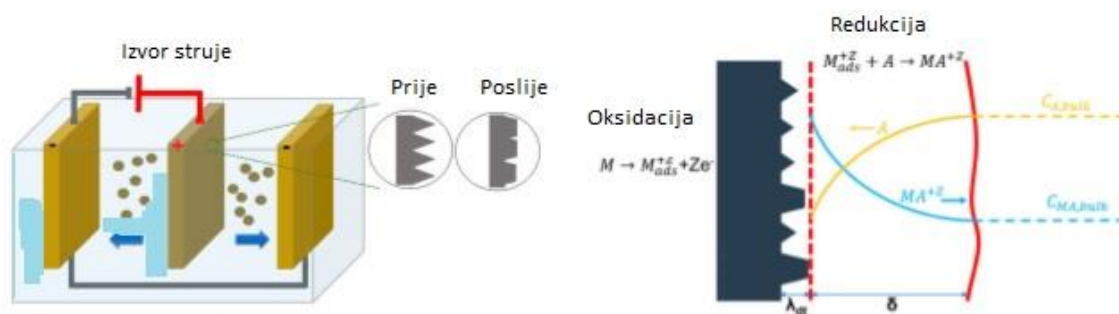
Slika 20. Shematski prikaz procesa elektropoliranja [19]
