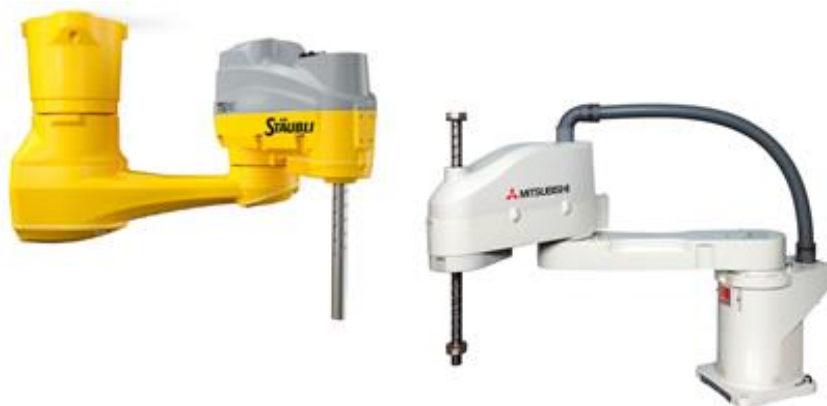
Slika 6 SCARA manipulatori tvrtke Staübli (stropno montirani) i tvrtke Mitsubishi
