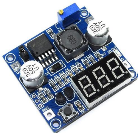
Slika 27. Modul za spuštanje napona LM2596-2 [18]
