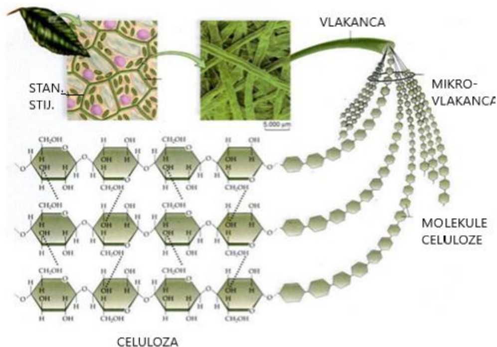
Slika 4.3 Formiranje vlaknaca od molekula celuloze [20]
