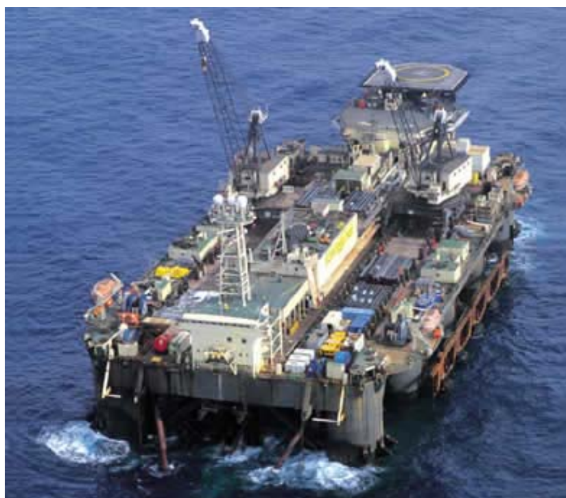
Slika 2.4 Castoro Sei – barža za polaganje cjevovoda S - tipom
