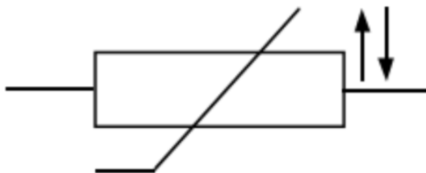
Slika 2.3 Simbol NTC otpornika
