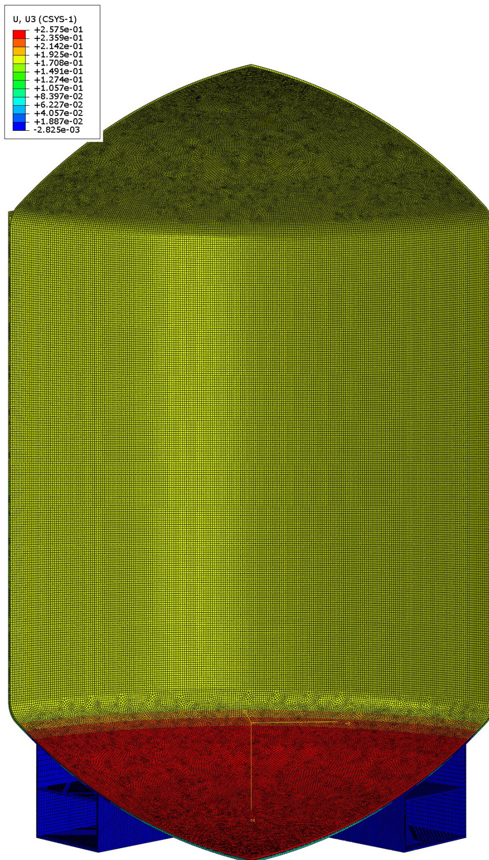
Slika 53. Raspodjela vertikalnog pomaka spremnika
