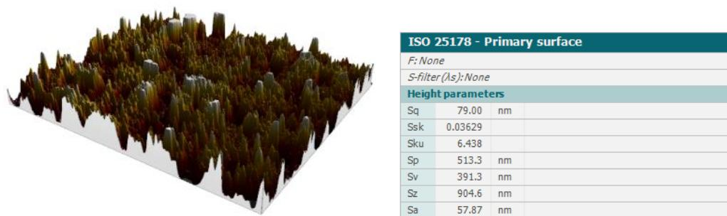
Slika 26. Uzorak 1 – 3D prikazi i 3D parametri topografije
