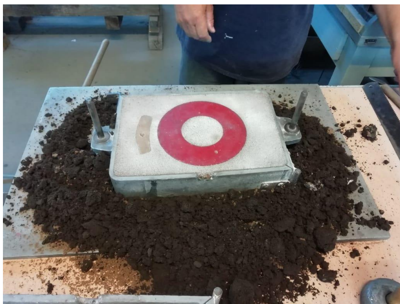
Slika 39. Model diska i razvodnika u donjaku.
