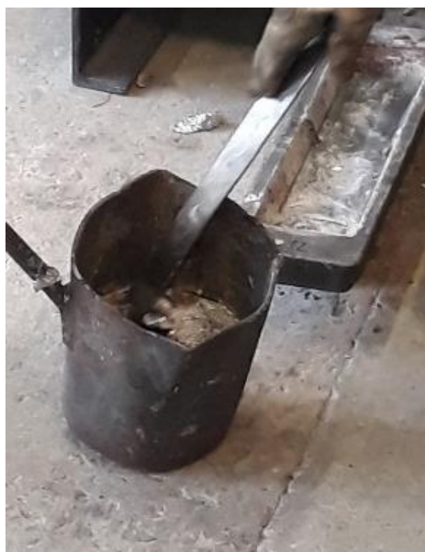
Slika 49. Čišćenje aluminijevih oksida sa površine taljevine.
