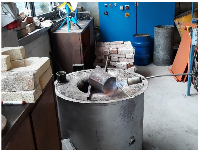
Slika 46. Zagrijavanje lonca za lijevanje taljevine.
