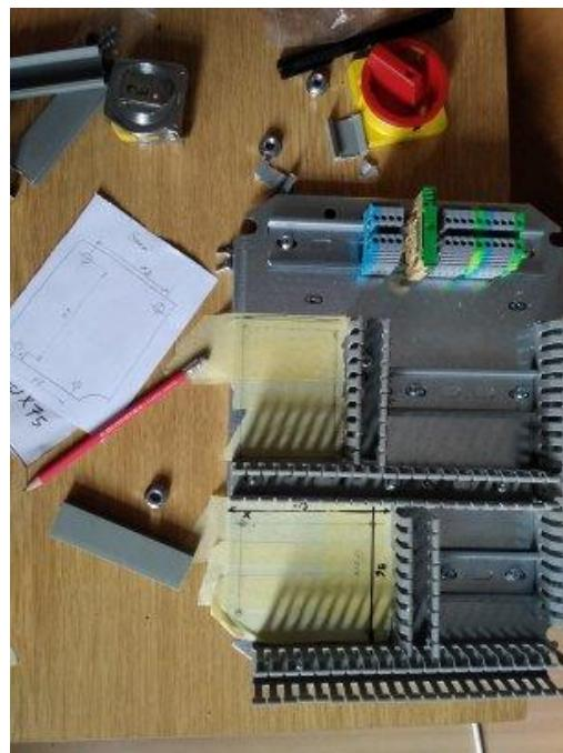
Slika 29. Montiranje uzdužnih kabelskih kanala
