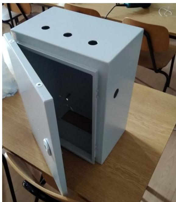
**Slika 31. Probušene rupe u razvodnom ormaru**
