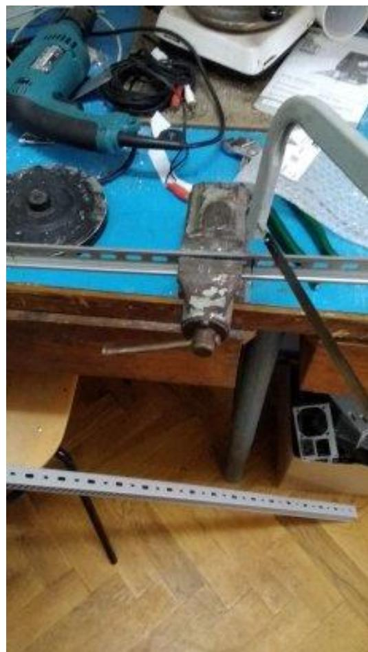
**Slika 27. Piljenje montažnih nosača**
