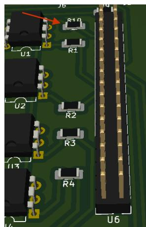
Slika 22. SMD otpornici na pločici (KiCad prikaz)
