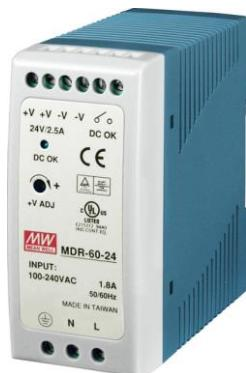
Slika 10. Elektronički izvor napajanja [6]
