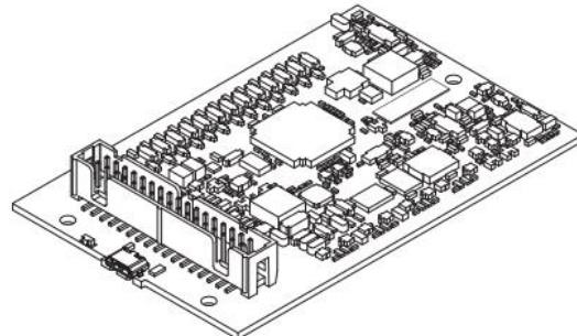
Slika 17. NI USB – 6001 (bez kućišta)
