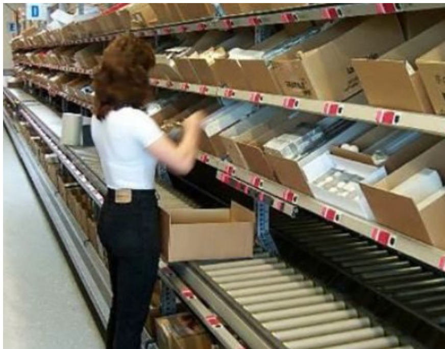
Slika 4. Svjetlom usmjereno komisioniranje [1]
