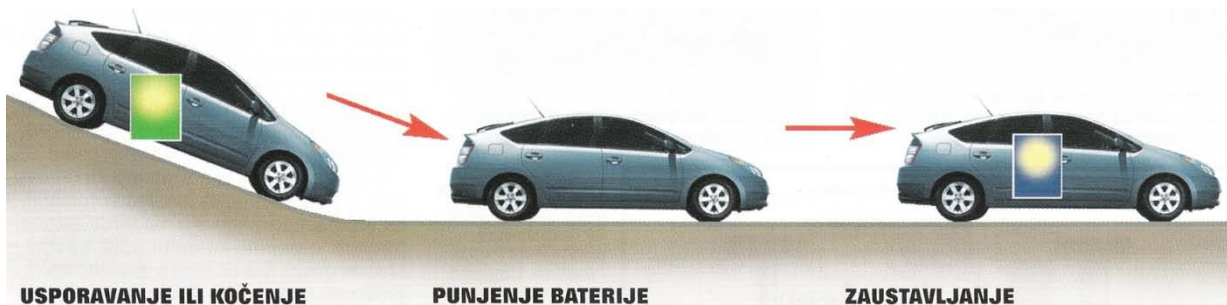
Slika 2.13. HSD-sustav (usporavanje - zaustavljanje)
