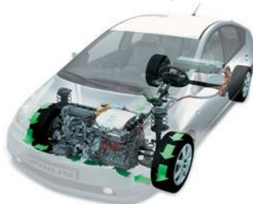
Slika 2.3. Pogonska osnova Toyote Prius - elektromotor i benzinski motor kod Priusa su smješteni poprečno naprijed
