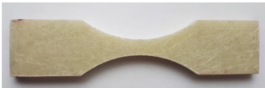
Slika 6.2 Primjer FRP uzorka za vlačni test
