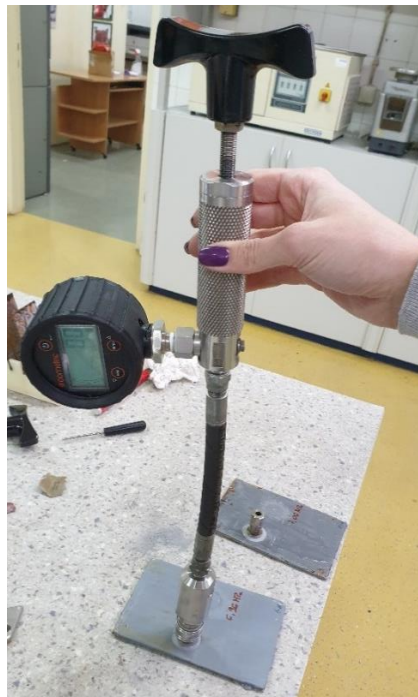
Slika 7.48 Ispitivanje prionjivosti premaza Pull – off metodom
