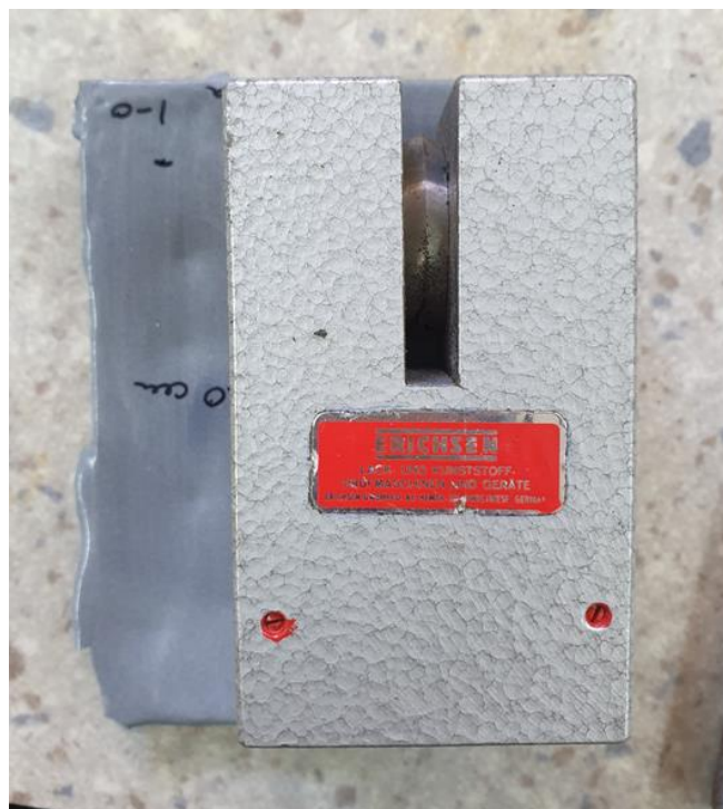
Slika 7.38. Ispitivanje tvrdoće prema Buchholzovom modelu 263
