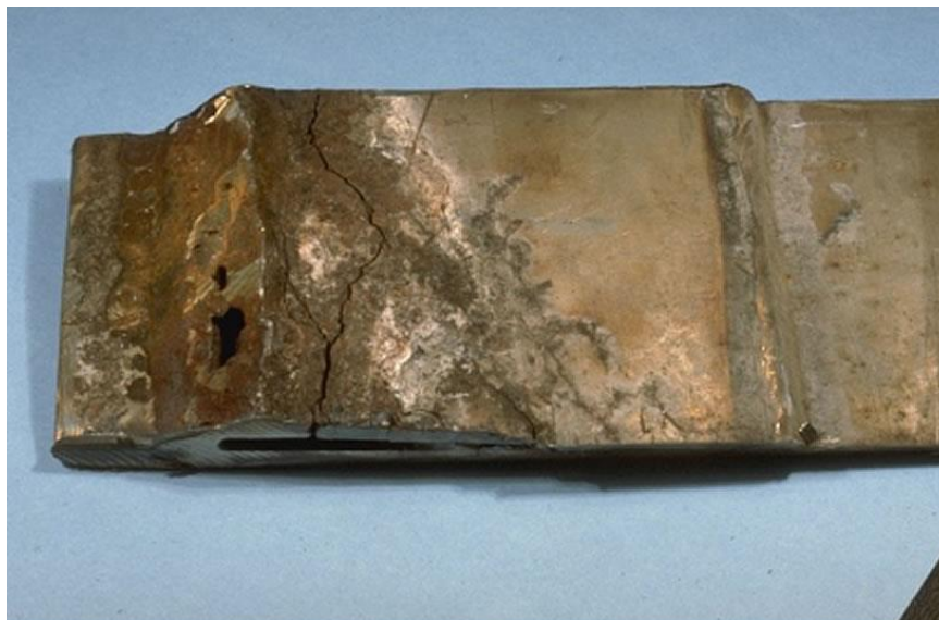
Slika 2.8. Napetosna korozija visokolegiranog čelika [5]
