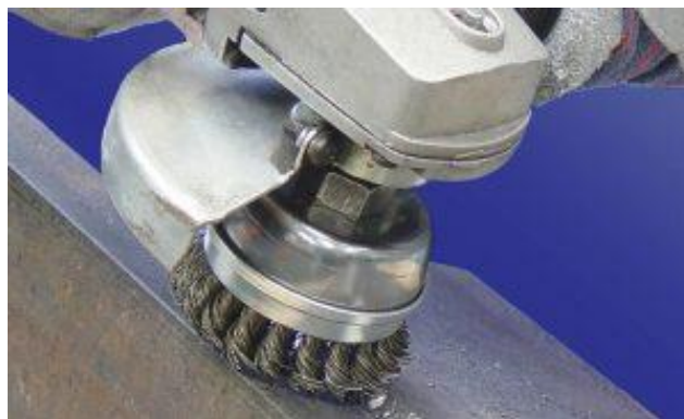
Slika 6.3. Rotacijska žičana četka [27]
