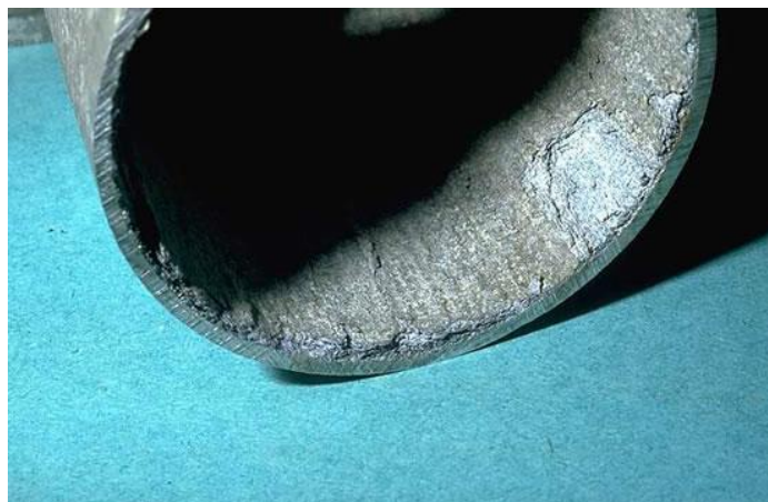
Slika 2.5. Morfologija interkristalne korozije unutar cjevovoda za vodu [5]
