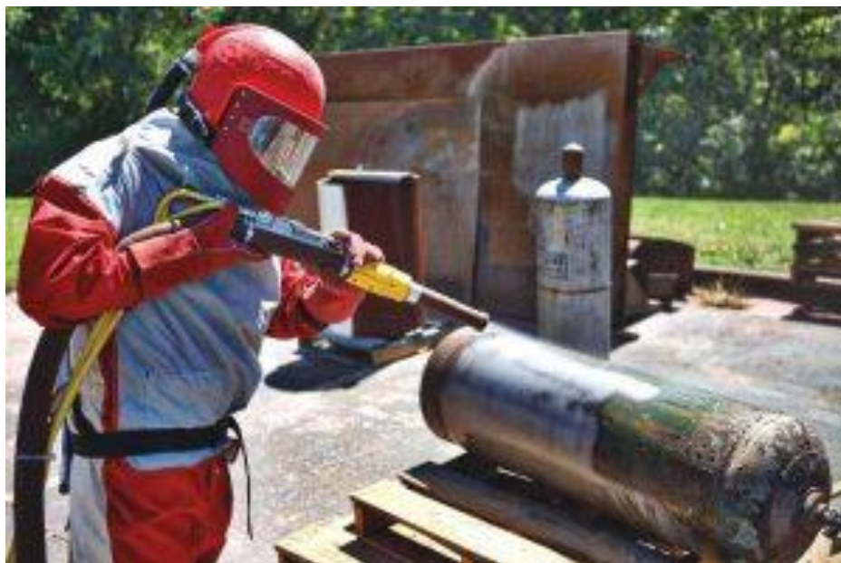
Slika 6.5. Čišćenje suhim abrazivom [27]
