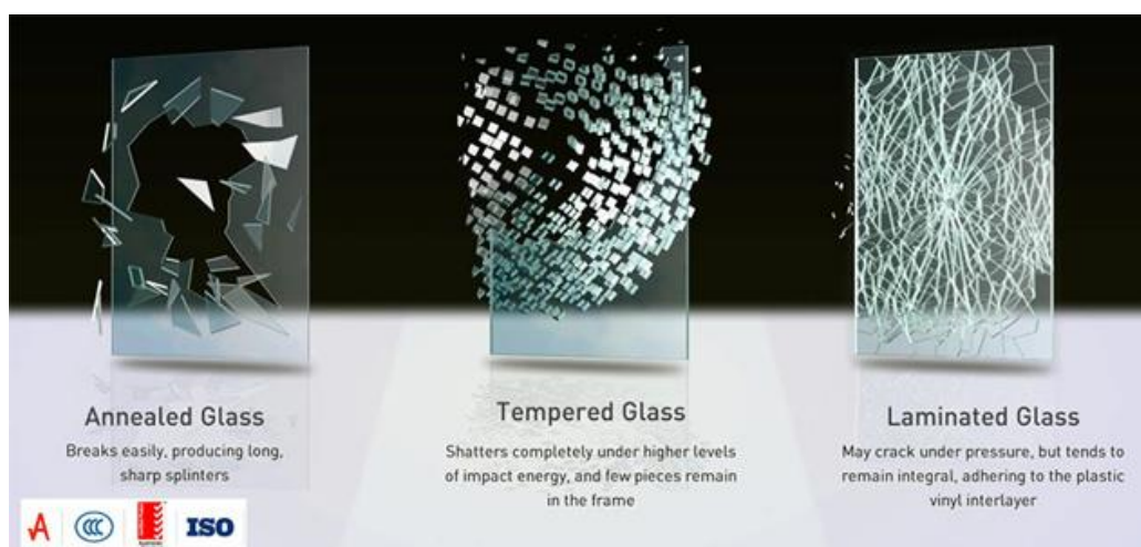
Slika 18. Usporedba različitih tipova stakla uslijed pucanja
