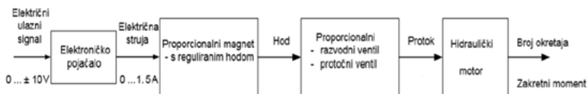
Slika 4.4. Otvoreni upravljački krug proporcionalnog hidrauličkog sustava [11]
