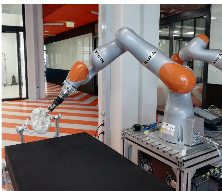
Slika 33. Prikaz kuta i pozicije robota potrebnog pri operaciji lijevog trigeminalnog ganglija
