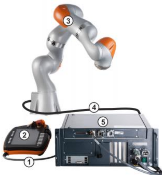
Slika 38. Dijelovi robotskog sustava KUKA LBR Med. 1) Kabel za spajanje na smartPAD 2) KUKA smartPAD upravljačka ploča 3) Manipulator 4) Priključni kabel za robotski kontroler KUKA Sunrise Cabinet 5) Robotski kontroler KUKA Sunrise Cabinet [27]
