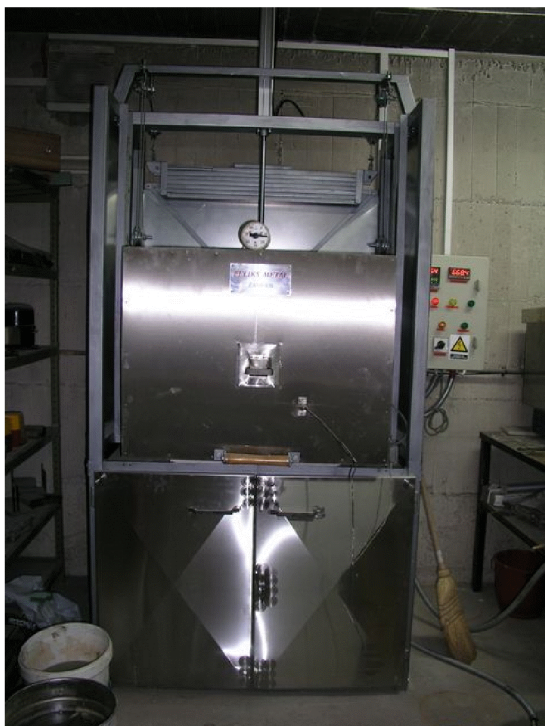
Slika 6.1. Izgled korištene elektrootporne peći
