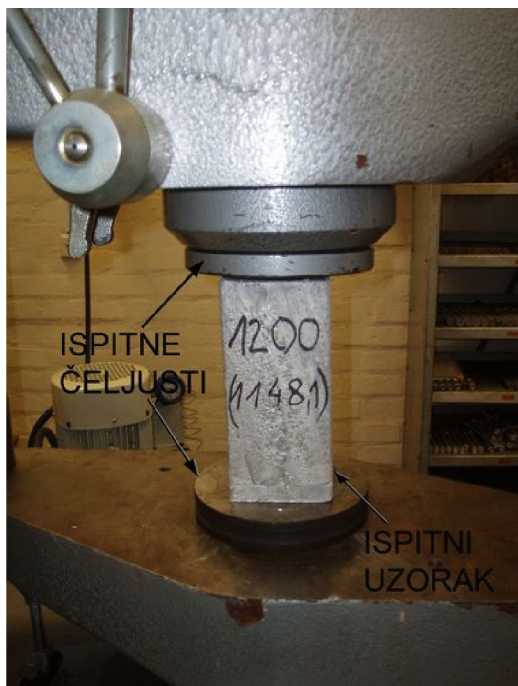
Slika 6.14. Prikaz uzorka na početku ispitivanja.
