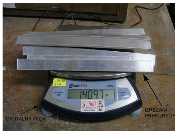
Slika 6.5. Vaganje prekursora na definiranu masu uzoraka.
