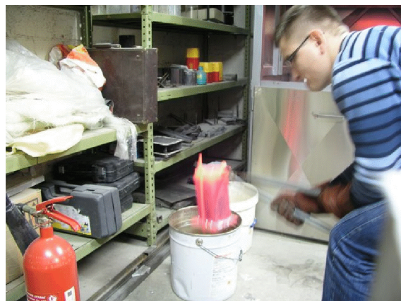
Slika 6.9. Prikaz gašenja kalupa u vodi.
