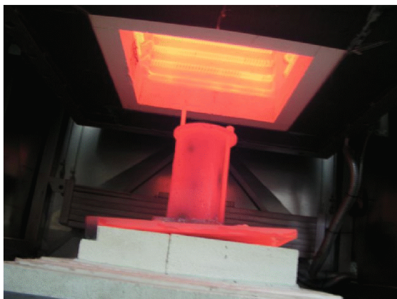
Slika 6.8. Izgled kalupa neposredno prije vađenja iz peći.
