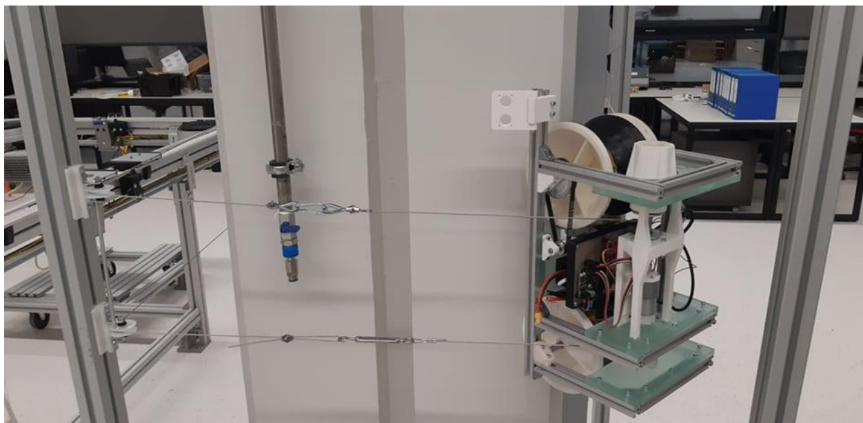
Slika 9.8. Uspinjanje prototipa po stupu uz pomoć testnog postava
