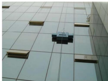
Slika 1.3. WSR: Model-I, robot za čišćenje ravnih staklenih površina [7, p. 3]
