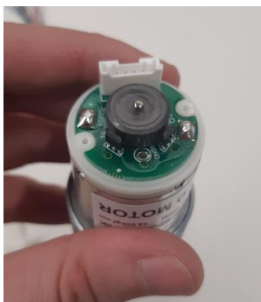
Slika 4.14. Hall efekt senzori na motoru
