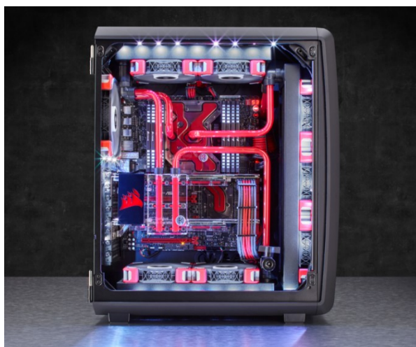
Slika 48. Osobno računalo hladeno vodenom petljom [40]
